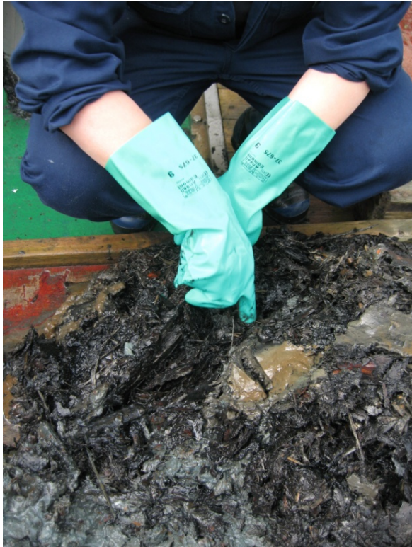
Träfibrerna har en mycket obehaglig, stark lukt av svavelväte och petrolium. Hela provet är reducerat. Materialet är inte lämpligt att ta i med bara händer.
