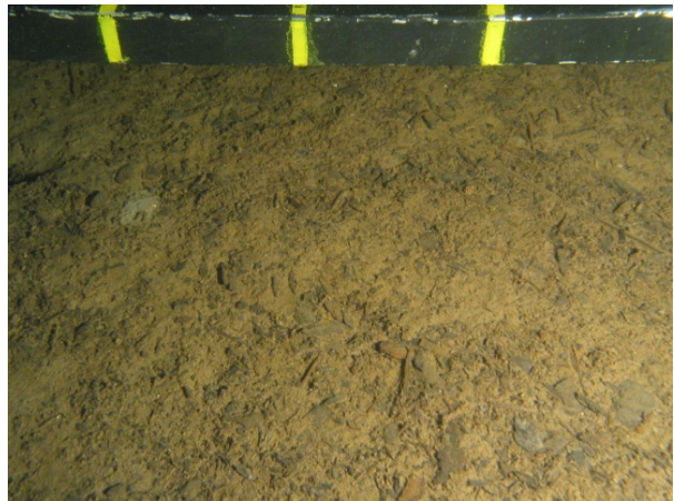
Träfibrerna har en mycket obehaglig, stark lukt av svavelväte och petrolium. Hela provet är reducerat. Materialet är inte lämpligt att ta i med bara händer.
