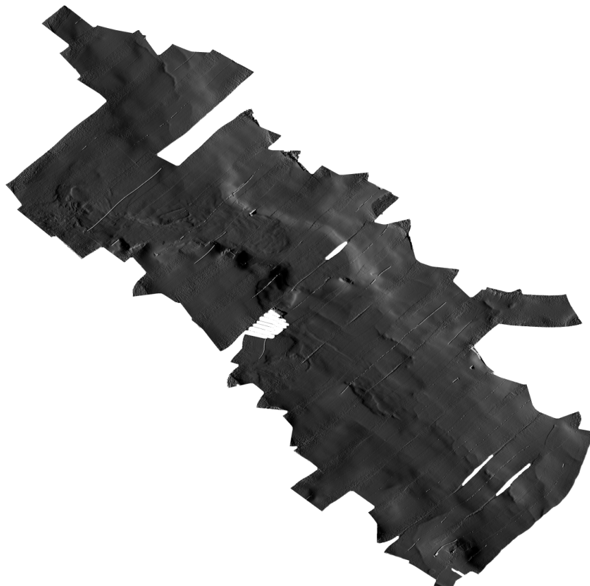
Figur 41. Terrängmodell, framtagen från mätningar med SGUs swathsonar, över område K.
