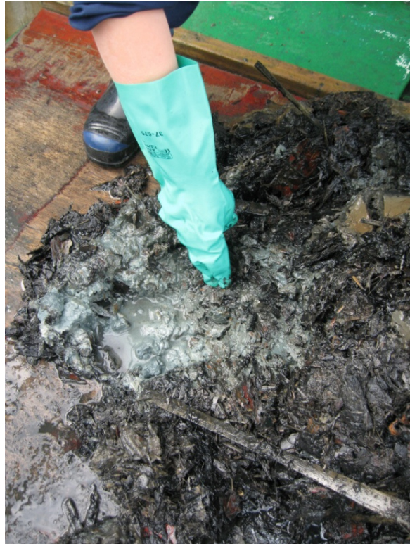
Träfibrerna har en mycket obehaglig, stark lukt av svavelväte och petrolium. Hela provet är reducerat. Materialet är inte lämpligt att ta i med bara händer.
