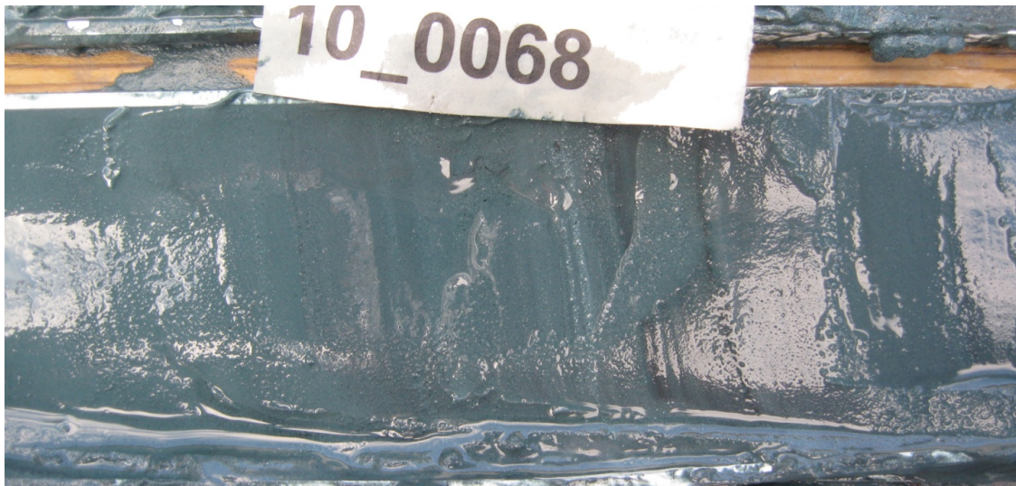
Under fiberbanken består kärnan till största delen av gyttjig silt.
