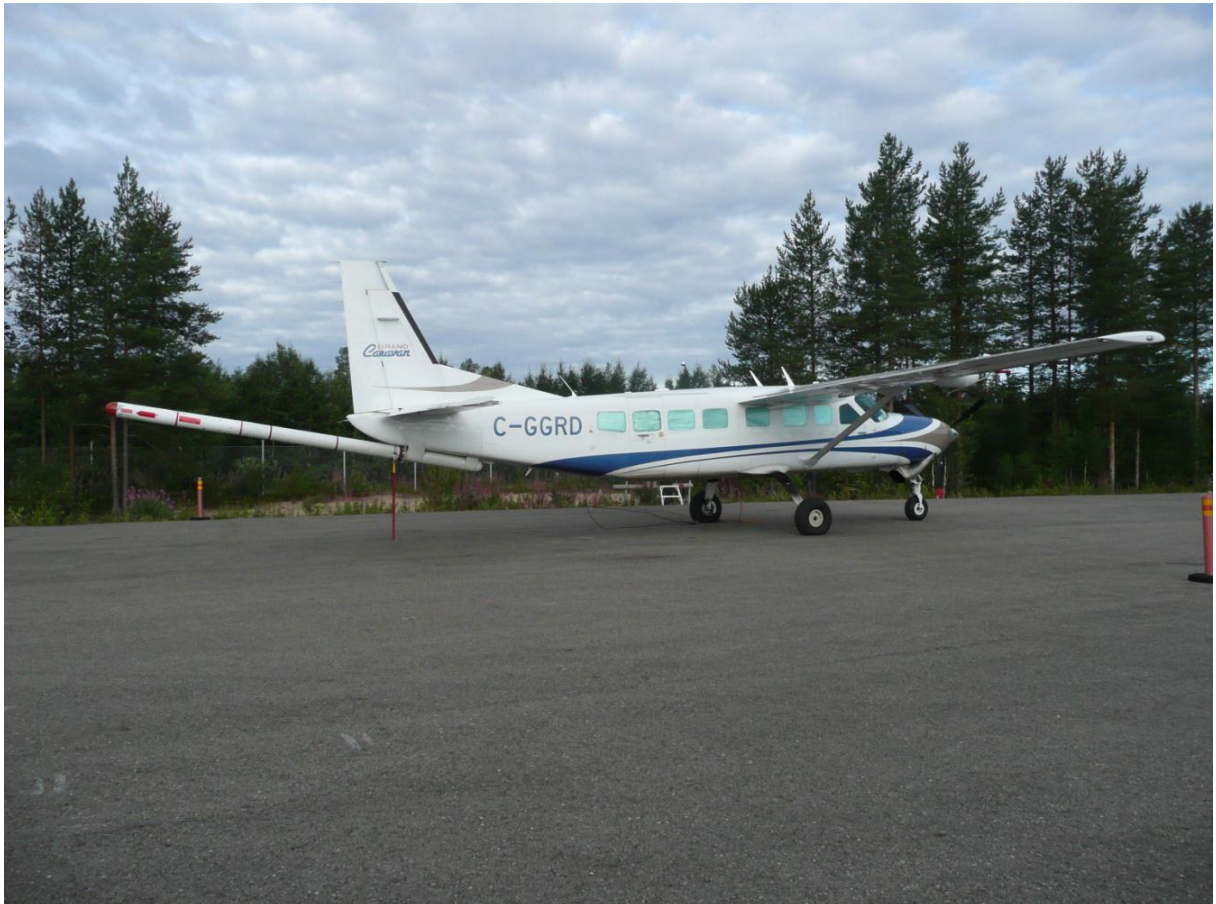
Bild 1. Mätflygplanet, Cessna 208 Grand Caravan med Fugros Falcon-system monterat. Foto: Heikki Salmirinne, GTK.
