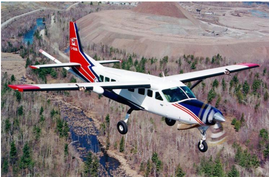
Bild 2. Mätflygplanet med Sander Geophysics gravimetersystem monterat.
