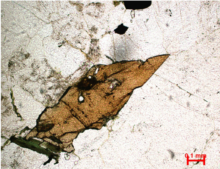
Figur 26. Titanitrik kvarts-monzonit av Edeforstyp. Euhedral titanit med inneslutningar av apatit omgiven av mikroklin och biotit.
