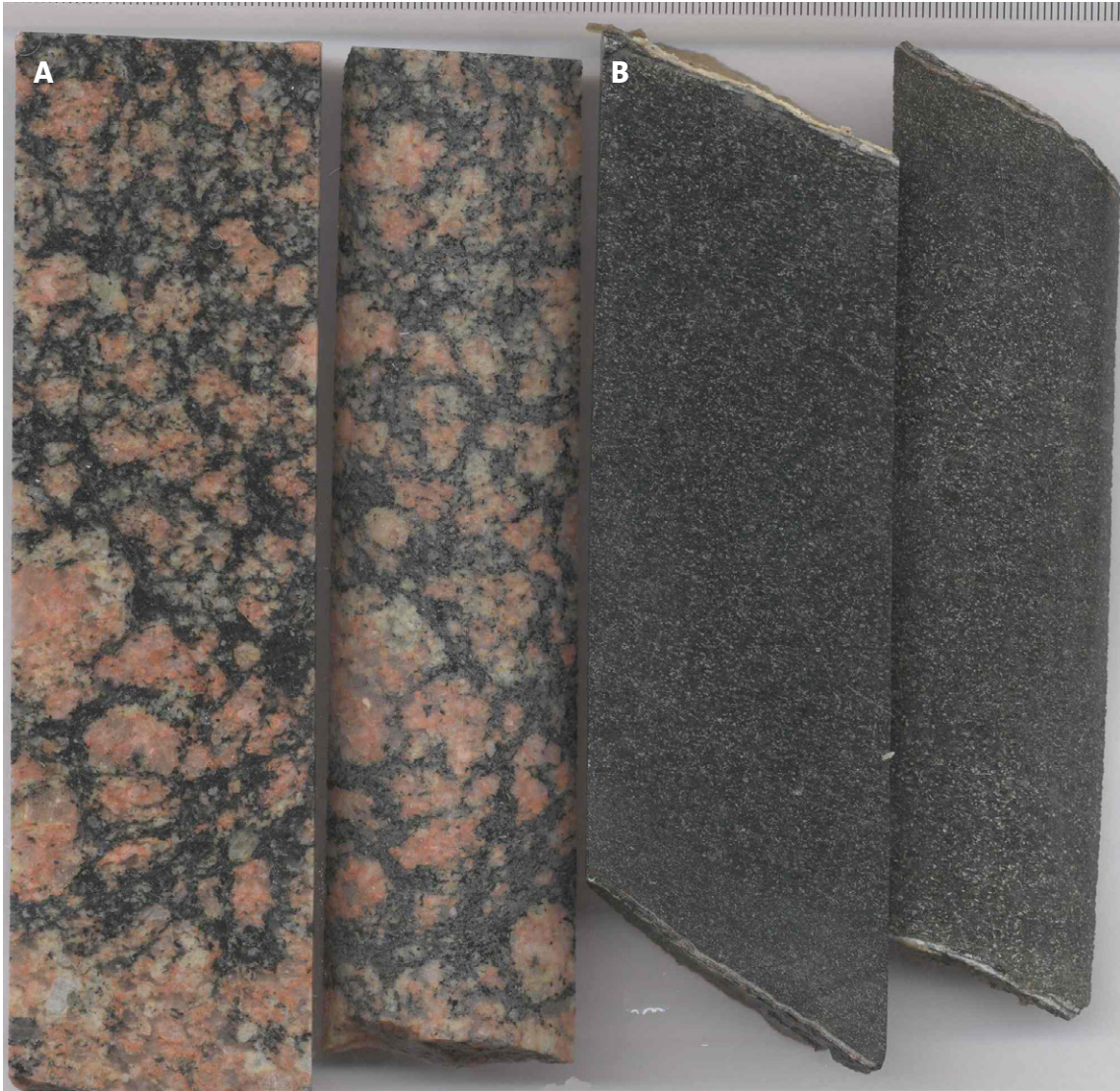
Figur 3. Undersökta bergprov. A. Rödgrå, ojämnkornig till porfyrisk, granitisk gnejs (Prov KK607KBH: 17,20–17,38 m). B. Biotitamfibolit, mörkt grå, svagt gnejsig (KK607KBH: 36,75–36,90 m). C. Snittyta vinkelrätt mot borrhålsaxeln som visar stängligheten i graniten i "A".
