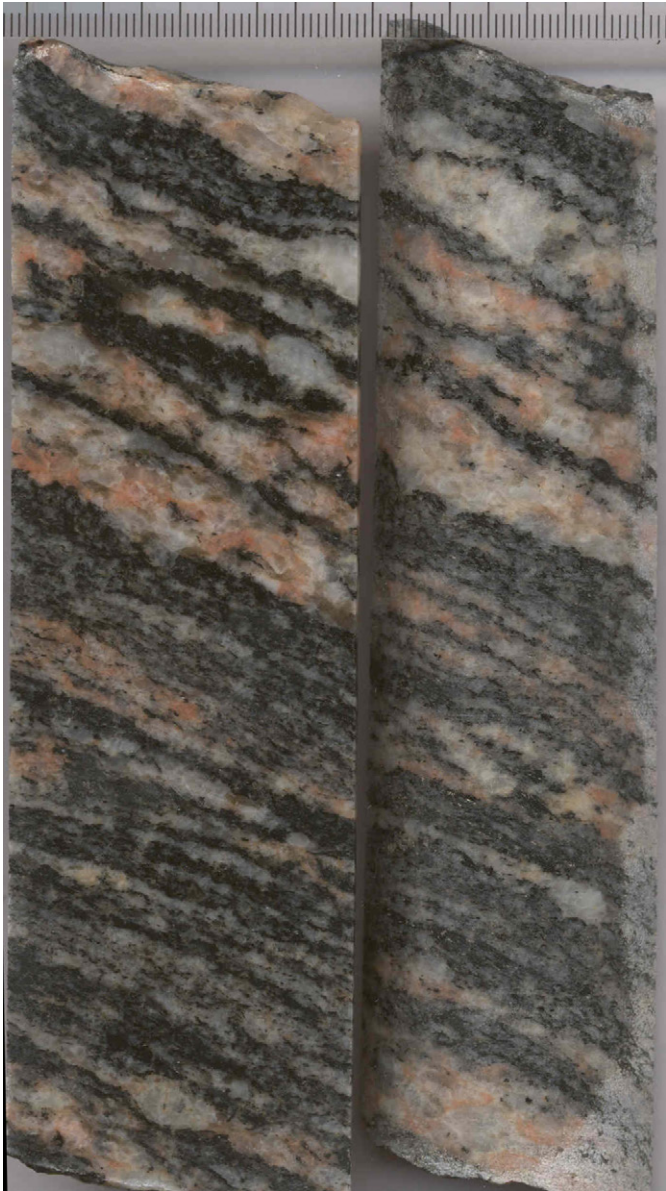
Figur 4. Undersökt bergprov av ådrad granodioritisk gnejs (KA612KBH: 28,40–28,73 m).
