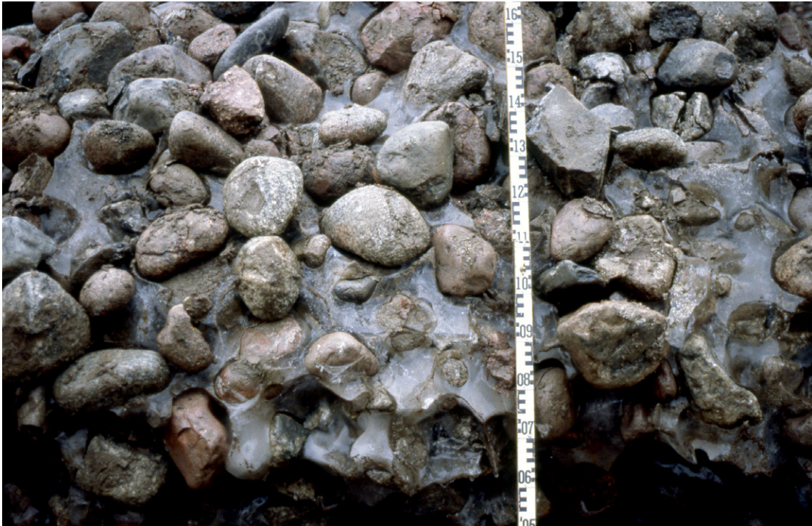
Figur 4. Det grova, iscementerade "gruset" i Bålsta. Hållrummen mellan rullstenarna saknar i stort sett finare fraktioner men är däremot helt fyllda av is. Den synliga delen av mätstången är 1,2 m lång. Foto: Robert Lagerbäck.
