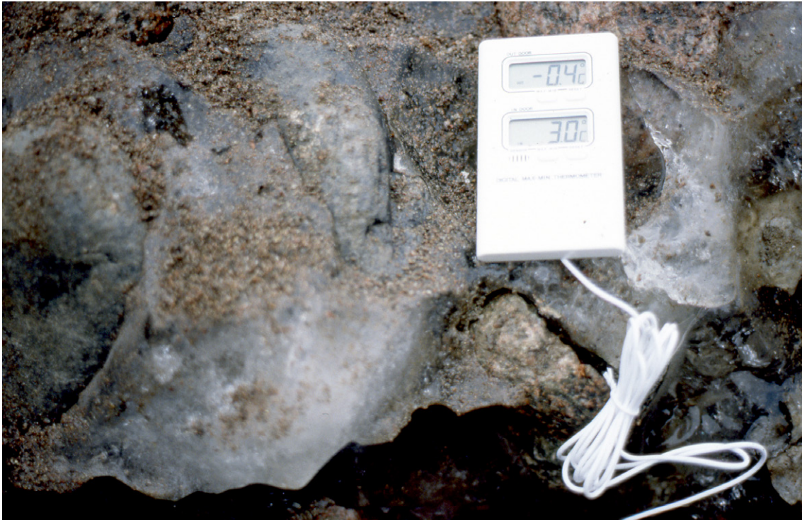
Figur 6. En enkel temperaturmätning i ett hål som borrats in i isen vid Bålsta visade -0,4^{\circ}\text{C} . Det isfyllda gruspartiet hade dock varit exponerat för uteluften under flera dagar så den ursprungliga temperaturen hade sannolikt varit lägre. Foto: Robert Lagerbäck.
