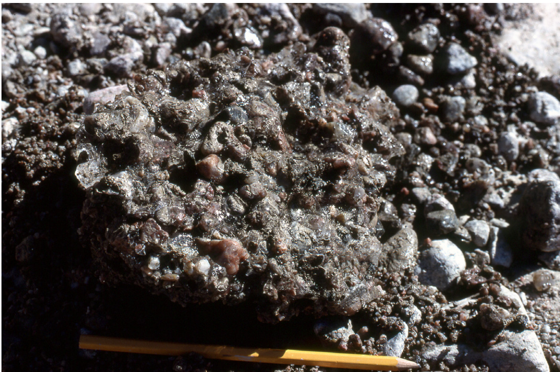
Figur 1. Klump av iscementerat grus i tälkten vid Kungsör. Mellanrummen mellan de enskilda gruskornen och stenarna är uppfyllda av is. I andra partier av det frusna gruset var stenarna betydligt större. Nederst i bild en blyertspenna som skala. Foto: Robert Lagerbäck.
