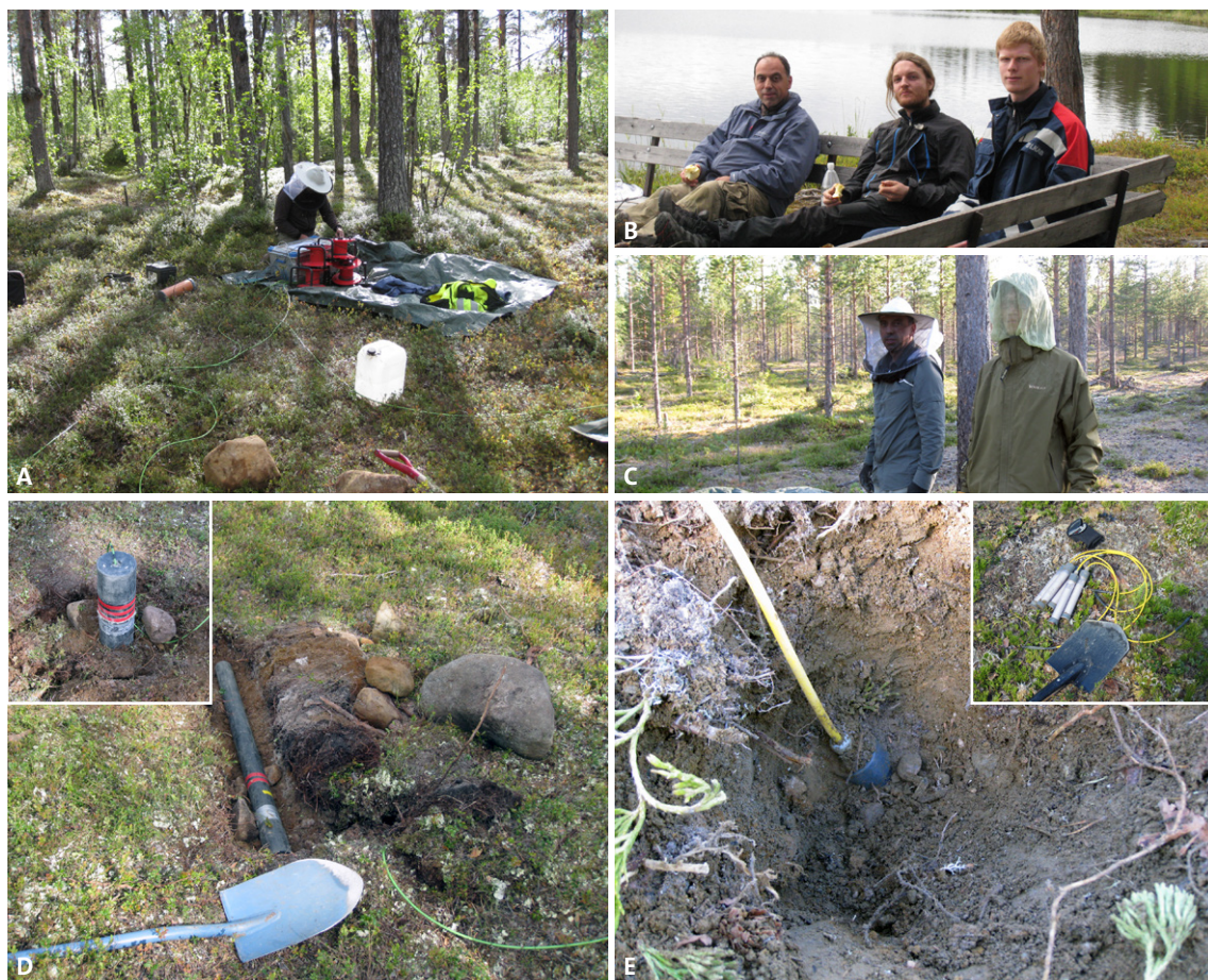
Figur 2. Fotografier från fältarbetet. A. Inställning av instrument. B–C. Extrageofysiker som har varit inblandade i fältarbetet. D. Magnetiska sensorer. E. Elektriska sensorer för MT mätningar. Foto: Mehrdad Bastani.
