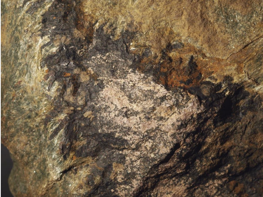
Figur 6. Zonerad, mycket REE-rik association i ljusgrönt amfibolskarn; finkornig ljus cerit-(Ce) sammanvuxen med mindre mängder bastnäsit-(Ce) med flera mineral, omges av en mera grovkristallin bård av svarta kristaller av ferriallanit-(Ce). Den här typen av prov kan innehålla flera tiotals viktprocent REE+Y. Från varpen vid Nya Bastnäsfältet, Riddarhyttan. Bildbredd cirka 5 cm. Foto: Erik Jonsson.
