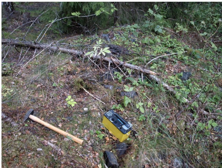
Figur 19. Användning av scintillometer för provtagning av radioaktiva järnmalmer. Dessa visade sig anrikade på REE och då specifikt neodym. Skärhyttefältet/Blankafors gruvfält. Foto: Erik Jonsson.
