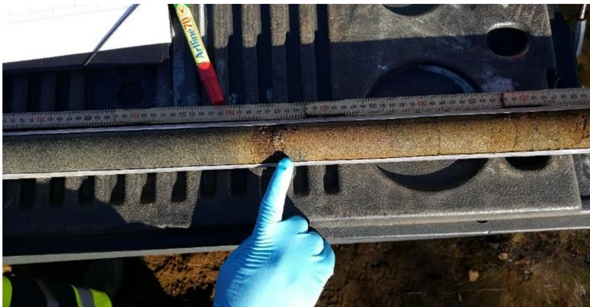
Bilden visar en borrhäna genom anrikningssanden i Smaltjärnens gruvdamm där färgskiftningen från röd/orange till grå/svart indikerar djupet som syre trängt ned och oxiderat både sulfider och danalit. Den röda färgen kommer från formationer av sekundära järnoxider. Foto: Lina Hällström.
