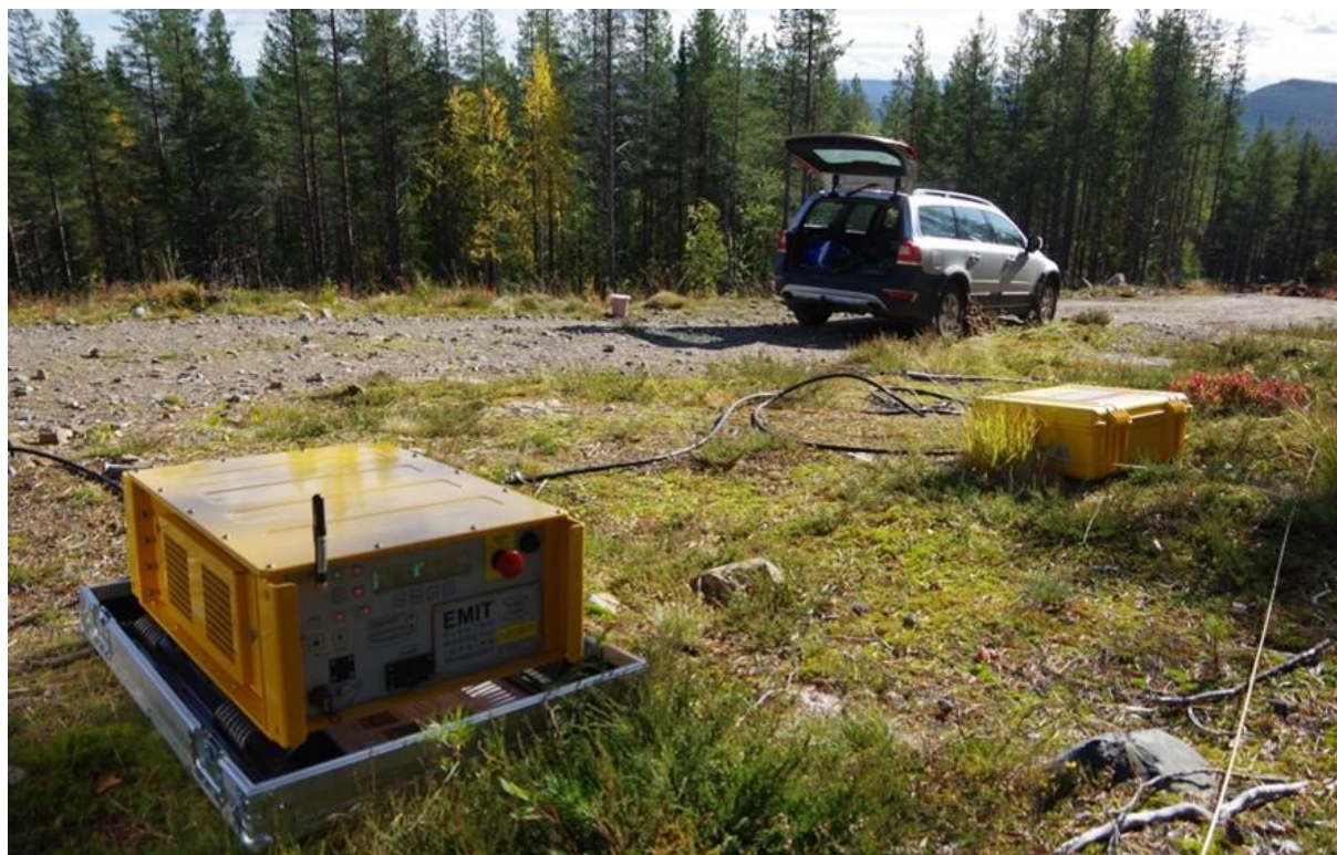
Elektromagnetisk transient mätning med sändare för elektromagnetisk signal i förgrunden. Foto Maxim Smirnov.
