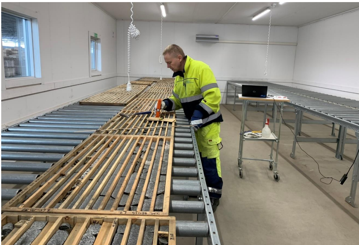
Figur 6. Mätning av magnetisk susceptibilitet på borrhärnor inför urval av provtagningssektion. Foto: Helge Reginiusen.
