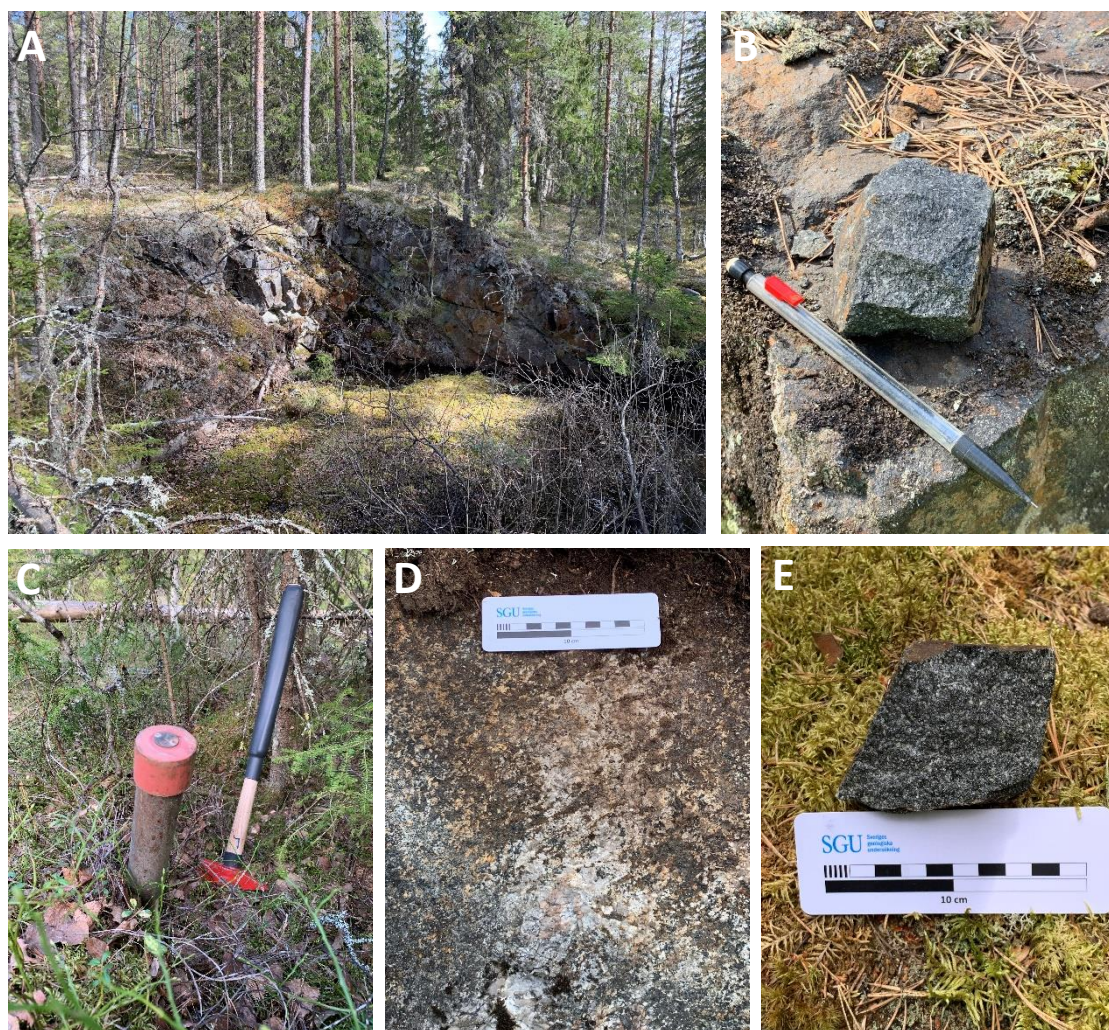
Figur 16. A. Gruvhål vid Masugnsberget (6871389/578211). Dimensionen på gruvhålet är cirka 10 × 15 m. B. Prov av gabbroid från varp vid gruvhålet i A. C. Borrhör från diamantborringar 1983 vid Masugnsberget (6871374/578316). D. Grovkornig gabbroid vid Blistra (6869735/578906). E. Prov av gabbroid från varp vid Blistra gruva (6869825/578489). Foto: Helge Reginius.
