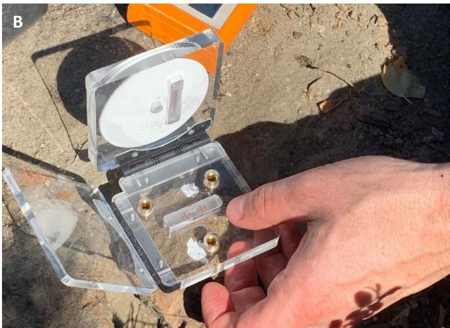
Figur 9. A. Vattenfyllt gruvhål vid Bläckmyran (6870542/584874). B. Mätning med solkompass innan provtagning av orienterat petrofysikprov i mafisk intrusion. Foto: Helge Reginiussen.
