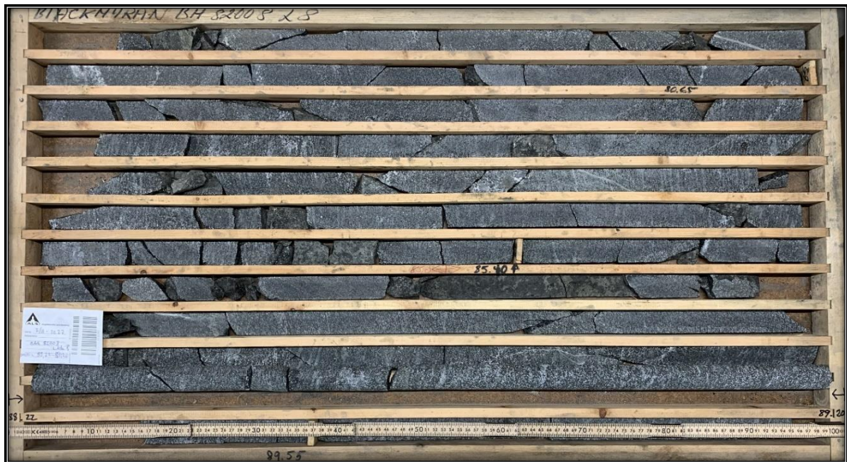
Figur 7. Exempel på borrhärnelåda från Bläckmyran (borrhål BLA82008) innehållande ungefär 12 meter borrhärna. I detta exempel provtogs sektionen 88,22–89,20 meter som gav följande analysresultat: \text{Fe}_2\text{O}_3 = 23,5 \% , \text{TiO}_2 = 3,2 \% , V = 0,14 \% . Foto: Helge Reginiussen.
