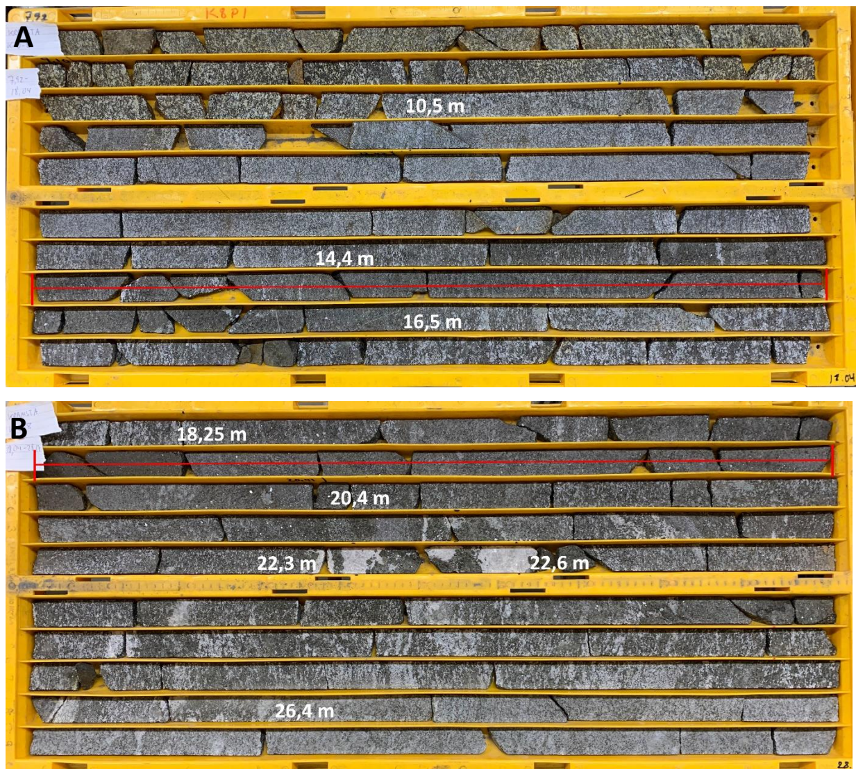
Figur 13. Ungefär 20 meter av borrhävarn K-D-8 från gabbroid vid Kramsta (6841552/559515). A. Intervall 7,92–18,04m. B. Intervall 18,04–28,17m. Sekvensen ger en bra illustration av primära texturer och modal lagring i bergarten. Ingen tektonisk deformation eller foliation observerades. Parallellorientering av avlånga mineral är resultatet av en magmatisk process. Röd markering visar urval av sektioner för litogeokemisk analys; 15,04–16,04 m (A.) gav följande analysresultat: \text{Fe}_2\text{O}_3 = 37,2\% , \text{TiO}_2 = 5,5\% och V = 0,25\% respektive 19,04–20,04 m (B.) gav \text{Fe}_2\text{O}_3 = 50,4\% , \text{TiO}_2 = 7,64\% och V = 0,36\% . Se text för detaljerad beskrivning av intervallen. Foto: Helge Reginiussen.
