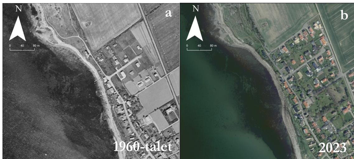
Figur 21. Kartorna visar den norra kusten i Nyhamnsläge. Bild a är ett historiskt ortofotografi som visar hur kusten såg ut på 1960-talet och bild b visar hur kusten ser ut i modern tid. Det ser ut som det har förekommit erosion i mittenpartiet, i synnerhet vid skoningen och viss ackumulation i söder. Huset längst ned till höger är huset högst upp till vänster i figur 22. Båda bilderna är gjorda i ArcGIS Pro genom kartdata från Lantmäteriet: historiska ortofotografier samt moderna ortofotografier som överlagras av I terrängskuggning från Lantmäteriets nationella höjdmodell.
