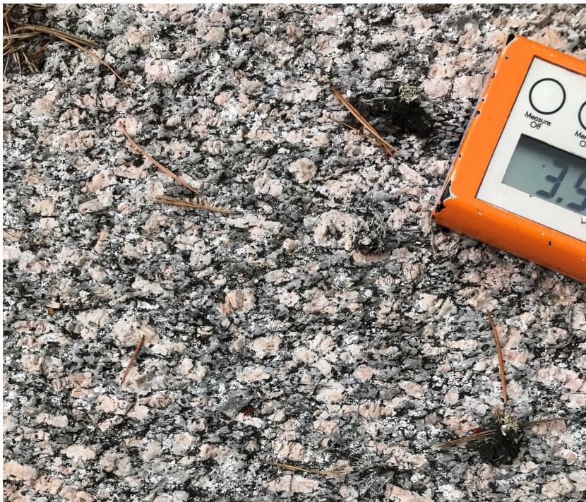
Figur 42. Postorogen porfyrisk granit från Jönåkerplutonen tillhörande den yngre Graversforssvitens bergarter. Bergarten är massformig, rödgrå med en medelkornig grundmassa. Listformade strökorn av mikroklin är cirka 1 cm i kornstorlek. SWEREF TM. Observation UJB200107, SWEREF TM 6515681 N/600626 E. Foto: Ulf Bergström, SGU.
