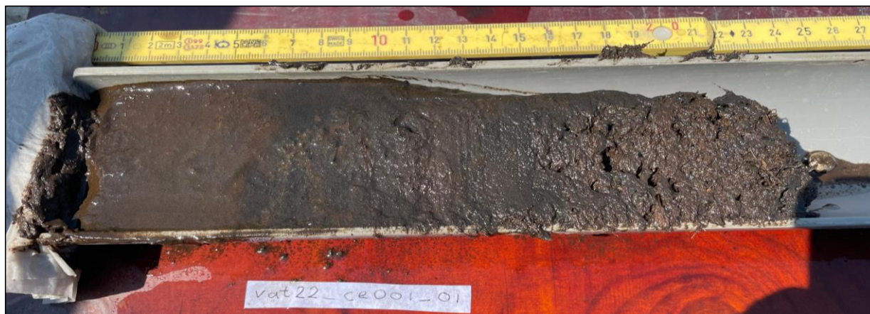
Figur 2. Sedimentkärna tagen med kajakprovtagare. Uppåt är till vänster i bild. Det som kommer 15 cm ner är förmodligen inte gyttja utan torv.
