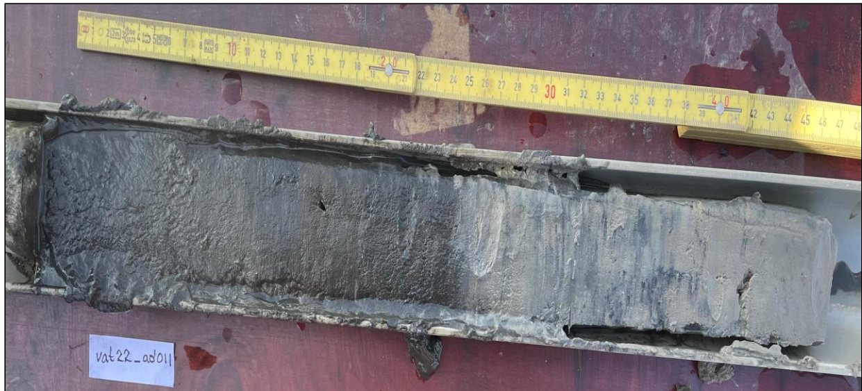
Figur 3. Sedimentkärna tagen med kajakprovtagare. Uppåt är till vänster i bild. Övergången vid 25 cm är väldigt tydlig m.a.p. redox och konsolidering så den utgör förmodligen en hiatus.
