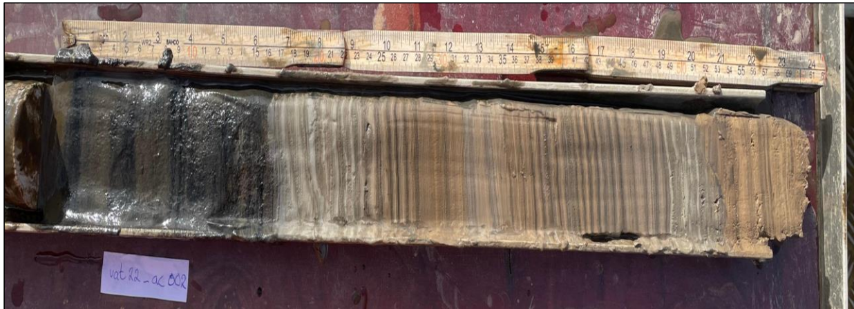
Figur 4. Sedimentkärna tagen med kajakprovtagare. Uppåt är till vänster i bild. Den nedre enheten (17-59 cm) har tydliga varv men det är osäkert om det är årsvarv.
