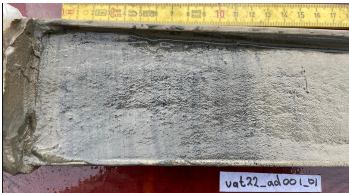
Figur 3. Övre delen av sedimentkärna tagen med kajakprovtagare. Uppåt är till vänster i bild. De översta 12 cm uppvisar mörkgråa reducerad skikt.
