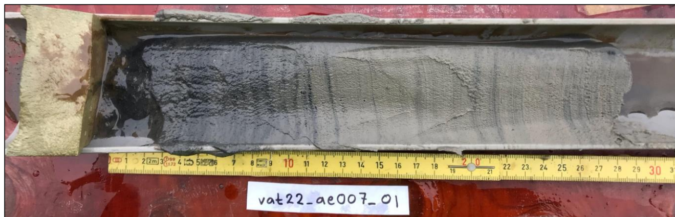
Figur 4. Sedimentkärna tagen med kajakprovtagare.
