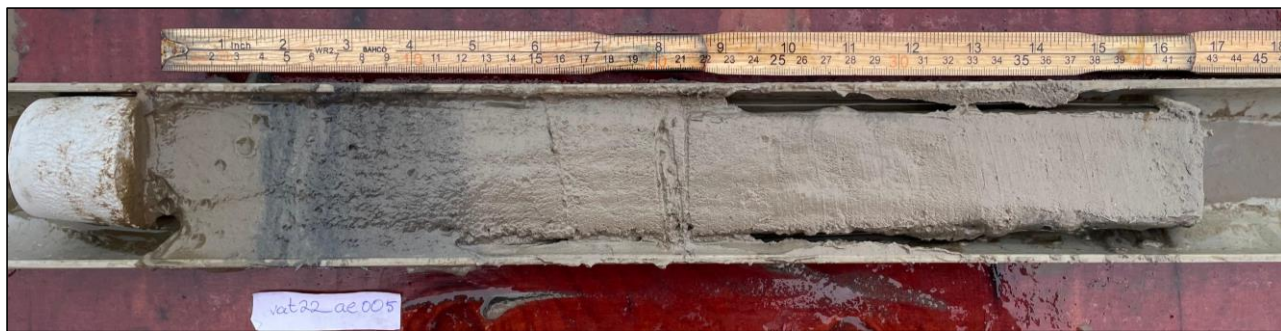
Figur 4. Sedimentkärna tagen med kajakprovtagare. Uppåt är till vänster i bild. Som på många andra lokaler i den här delen av Vättern så är det en tydlig konsolideringsgräns i samband med övergången, i detta fall vid ca 12 cm från en överliggande reducerad enhet ner till den underliggande oxiderade delen.
