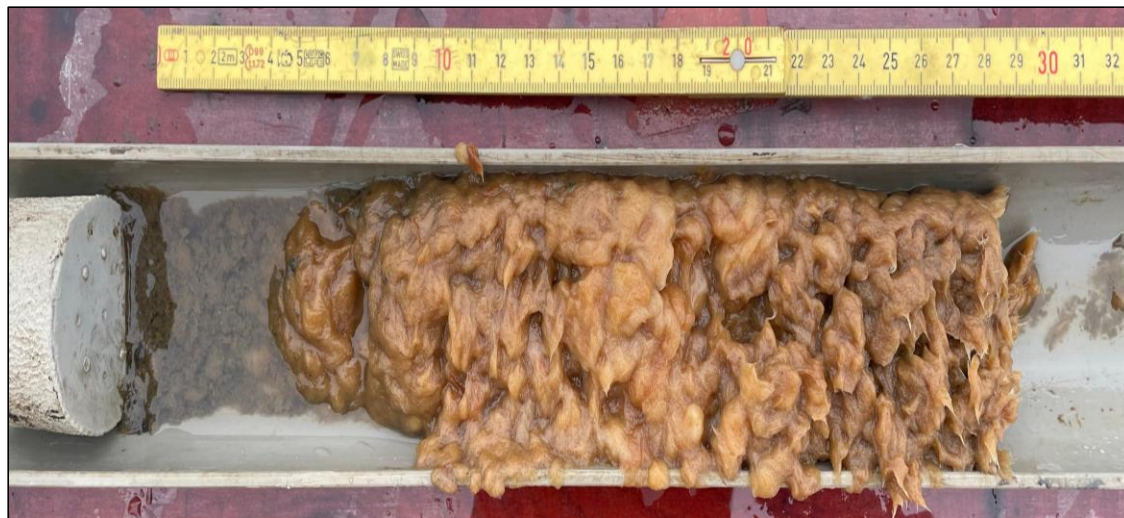
Figur 2. Övre delen av sedimentkärna tagen med kajakprovtagare. Uppåt är till vänster i bild. Under ett tunnt skikt lergyttja finns enbart massafibrer.
