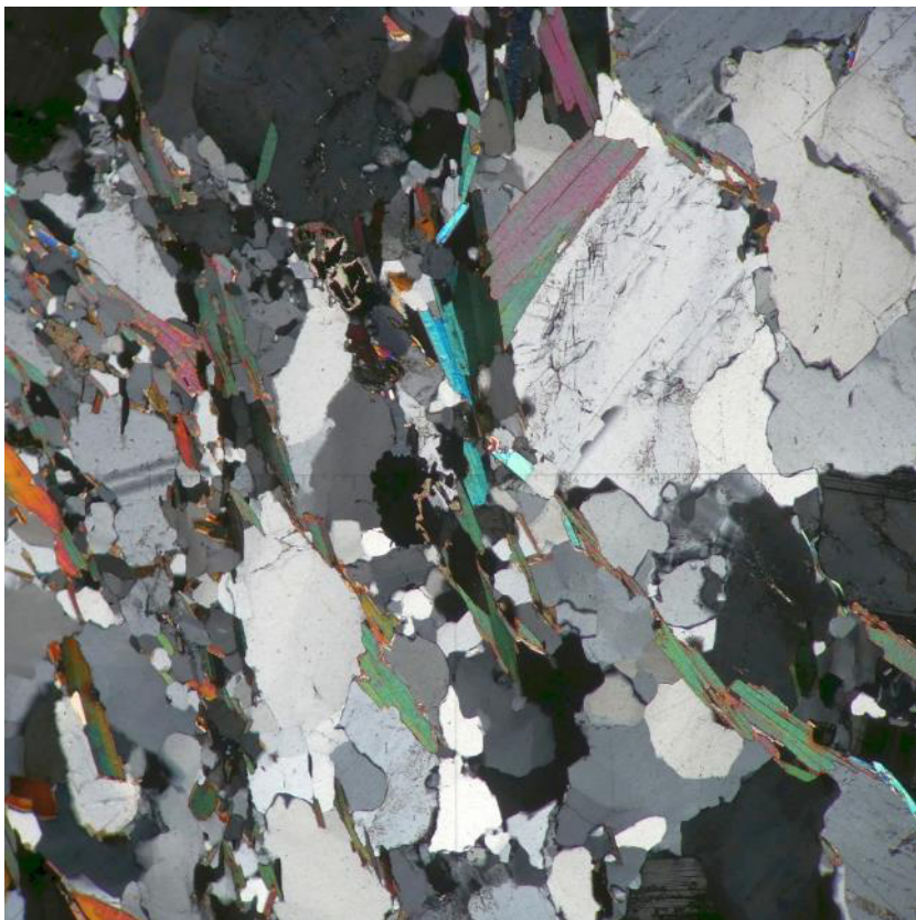
Figur 11c. Tunnslipsfotografi av bergprovet från östra delen av bergsryggen som begränsar skredområdet åt söder. Gnejsigheten definieras främst av strimmor och flakiga aggregat av glimmer (biotit och muskovit). Även strimmor av kvarts och fältspat bidrar till gnejsstrukturen. Svart kvadrat visar i bildområde reflekterat ljus i figur 12. Mus= muskovit. Bildbredd 2,5 mm.
