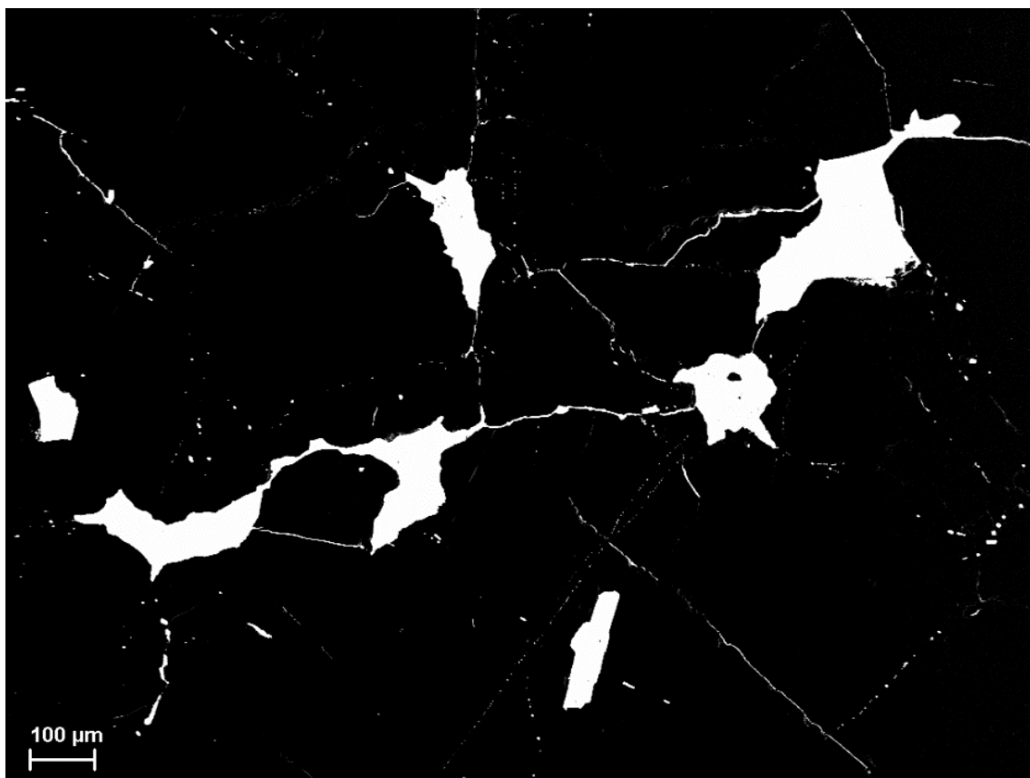
Figur 27. Höglkontrast-BSE-bild tagen med svepelektronmikroskop som visar den karakteristiska texturella fördelningen av malmmineral (i detta prov främst tellurider, sulfider, sulfosalter; BSE-vita) i kvartsdominerad grundmassa (svart) från Enåsengruvan. Den absolut största andelen av malmmineral uppträder alltså i mer eller mindre tydliga, ofta grovt sett triangulära öppningar eller förgreningspunkter, typiskt mellan korngränser i värdkvarts, i tunnare spricksystem, mestadels också utfyllda av malmmineral (alla BSE-vita). De tunnare spricksystemen kan både grovt följa korngränser (ofta bågformade sprickfyllnader) och även övertvåra dessa (oftast mer eller mindre tydligt raka sprickfyllnader). Båda typerna föreligger i denna BSE-bild. Observera att de allra tunnaste sprickfyllnaderna och minsta "pärlbanden" med mikro-malmmineralinneslutningar (se figurerna 28 och 29 nedan) ej syns i denna bild på grund av den förhållandevis låga förstoringen tillsammans med en (mycket) hög kontrast. Foto: Erik Jonsson.
