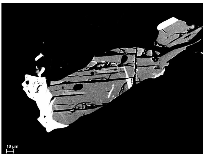
Figur 55. Högkontrast-BSE-bild tagen med svepelektronmikroskop. Bilden visar ett parallellstrukturerat (på grund av spaltning) aggregat av rickardit tillsammans med selenförande tellurobismutit (vita, stora otydliga aggregat i vänstra kanten samt skivig kristall överst till höger); vita kristaller eller lameller i hög vinkel till spaltningen utgörs av kostovit. Telluridaggregatet är i sin tur delvis sammanvuxet med kopparkis (här svart liksom kvartsen). Skallstreck 10 µm. Foto: Erik Jonsson.
