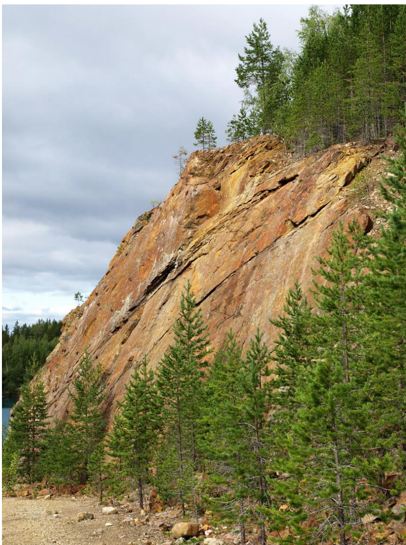
Figur 20. Den delvis mineraliserade liggväggen (notera rostfärgning) till Enåsengruvans malmzon, här exponerad i dagbrottets sydöstra del, direkt öster om rampvägen. Foto: Erik Jonsson.
