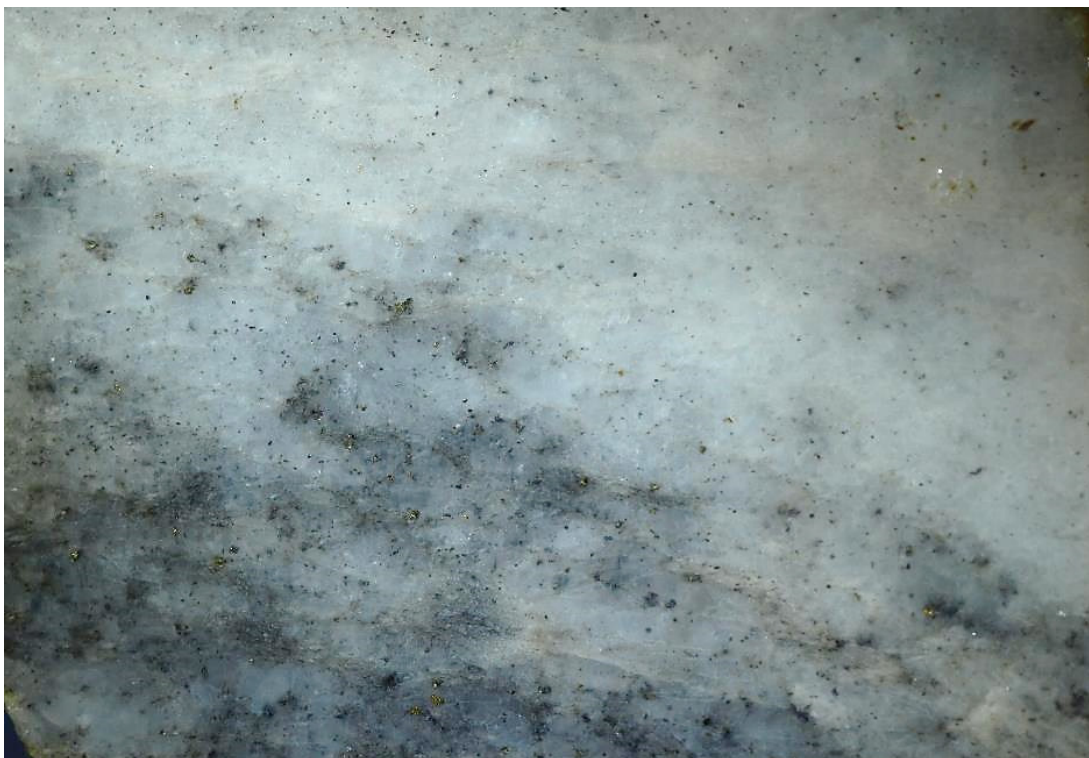
Figur 22. Närbild av sågad skiva av relativt sparsamt och ojämnt mineraliserad sillimanitkvartsit med disseminerade små korn av malmineral omfattande sulfider, sulfosalter och tellurider i och med flammigt mörkare gråtonad kvarts, till icke-mineraliserad ljusare eller vit kvarts. Vissa mycket små, mörka eller svarta korn är rutil. Bildbredd cirka 1,5 cm. Foto: Erik Jonsson.
