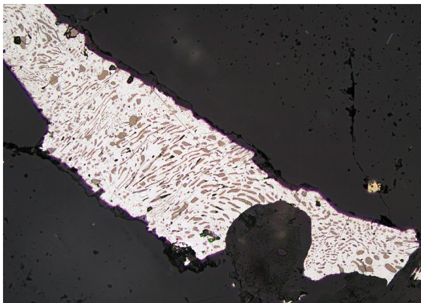
Figur 48. Fotomikrografi i planpolariserat påfallande ljus av en delvis mycket finskalig, heterogen symplektit av en vismuttellurid (med samman-sättning motsvarande en Se-förande tellurobismutit) med rikliga mask- till lins- eller droppformade, delvis orienterade inneslutningar av Se-Te-förande bornit (bruntonad). Den mörkgrå grundmassan domineras av kvarts och ett mindre, gult korn eller aggregat av kopparkis syns också inneslutet i den senare. Bildbredd cirka 500 µm. Foto: Erik Jonsson.
