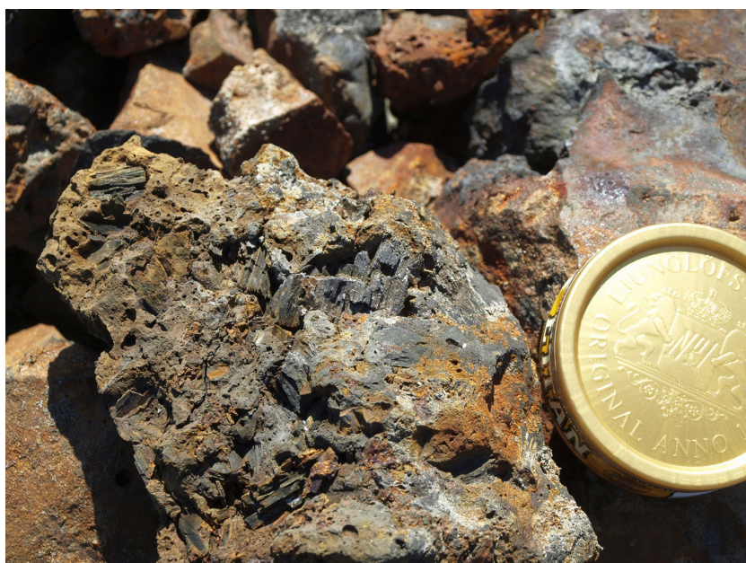
Figur 2. Exempel på en heterogen, sannolikt mycket gammal slagg med rundade gasblåsor (ursprungliga "luftbubblor") av olika storlekar samt rikliga och grova inneslutningar av framför allt (trä-)kol som rester från förhytningsprocessen. Förekomsten av lokala rostkoncentrationer visar på närvaro av inneslutningar av metall och/eller järnrika, lättvittrade metallsulfider. Gamla Berget, Falun. Snusdosa som skala: diameter 7 cm. Foto: Erik Jonsson.
