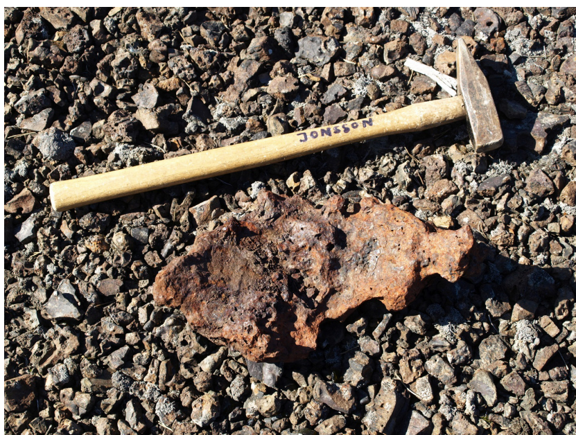
Figur 1. Exempel på större ansamling av metalliskt järn som hamnat i slaggen. Gamla kopparverket, Riddarhyttan. Foto: Erik Jonsson.
