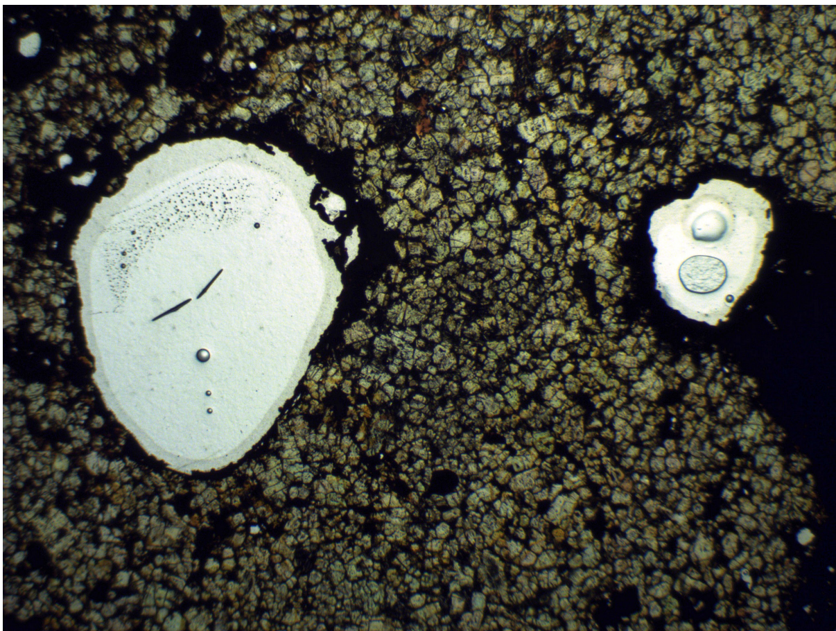
Figur 3. Bild av tunnslip från slagprov från Falun i genomfallande planpolariserat ljus; bildbredd ca 3 mm. Bilden visar en grundmassa dominerad av euhedra till subhedra kristaller av en ljusgrön till lätt bruntonad fayalitartad (järn-magnesiumsilikat) fas med en grundmassa (till dels dominerande, exempelvis i högra kanten av bilden) av mörkt eller svart glas. En del mera kantiga eller cirkelrunda svarta inneslutningar är sulfider och metallfaser. I de större glasansamlingarna uppträder också rundade bubblor (ursprungligen tomma), vilka nu är vita, fyllda med epoxy med, i sin tur, mindre luftbubblor i. Foto: Erik Jonsson.
