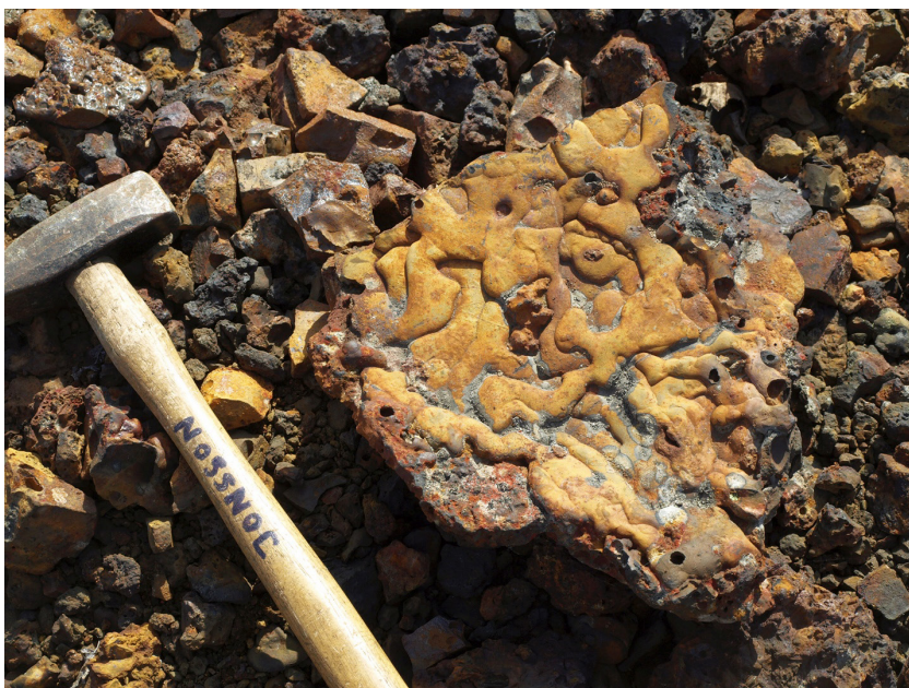
Figur 11. Slaggernas karaktär och kornstorlek kan variera avsevärt. Här ett block med tydliga flytvalkar, gasblåsor/-hålrum och andra strukturer som vittnar om ursprunget som smälta och dess snabba avkylning. Området kring Stora Stöten, Falun. Foto: Erik Jonsson.
