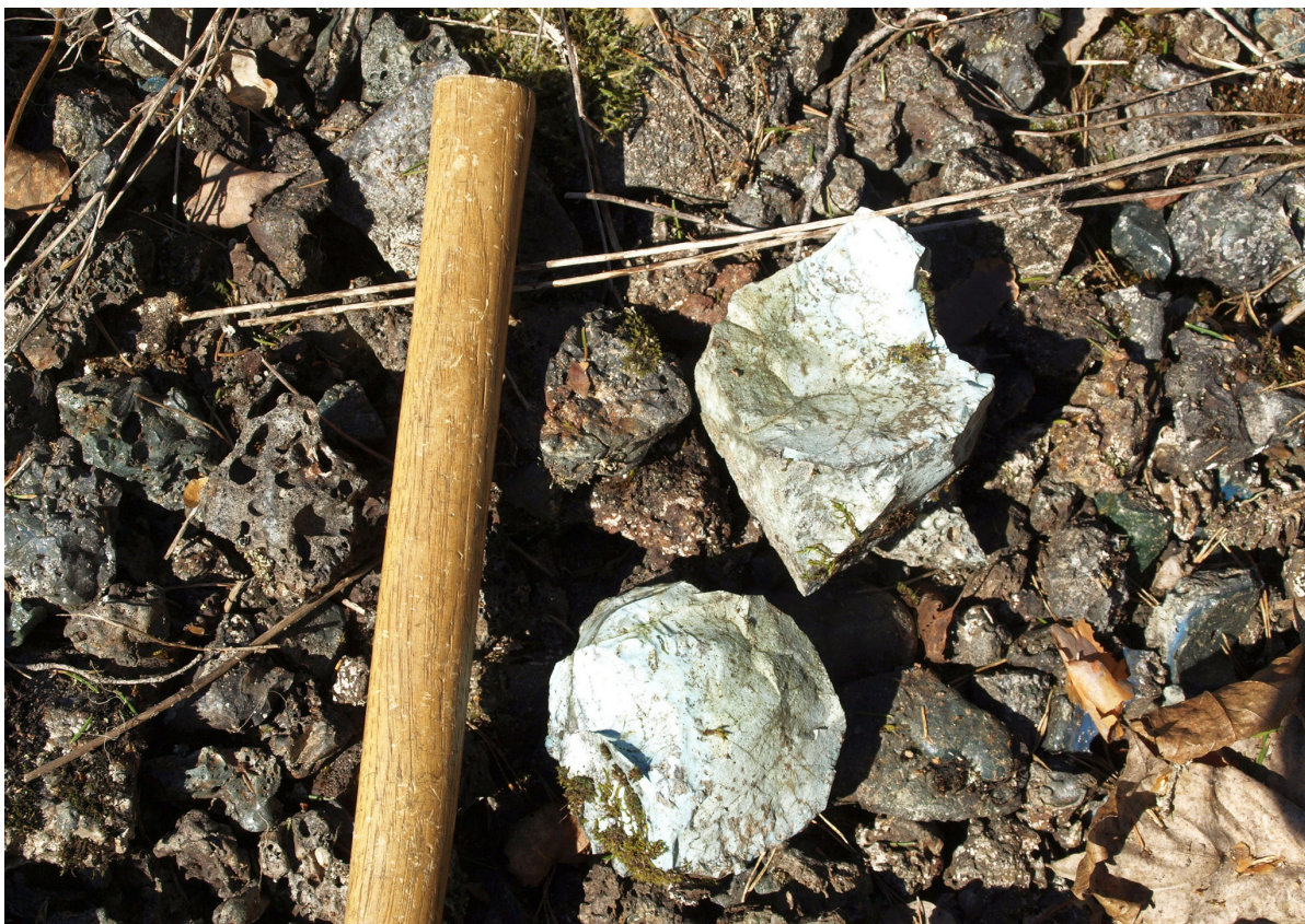
Figur 9. Olika typer av mestadels glasig slagg, från mörkt grå till grön med rikliga gasblåsor respektive relativt tät och ljusblå till nästan vit (höger om hammarskaftet) i den övervuxna slaggvarpen vid Skilå övre hytta. Foto: Erik Jonsson.
