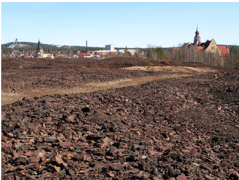
Figur 10. Mycket stora volymer hyttslaggar har ansamlats i och kring Falun genom århundraden av gruvbrytning och associerad förhyttning av de brutna kopparmalmerna. Här ett omfattande område med djup slagghvarp i området kring Hyttgårdsparken, väst-sydväst om centrala Falun. Hoppbacken vid Lugnet syns längst till vänster i bakgrunden. Foto: Erik Jonsson.
