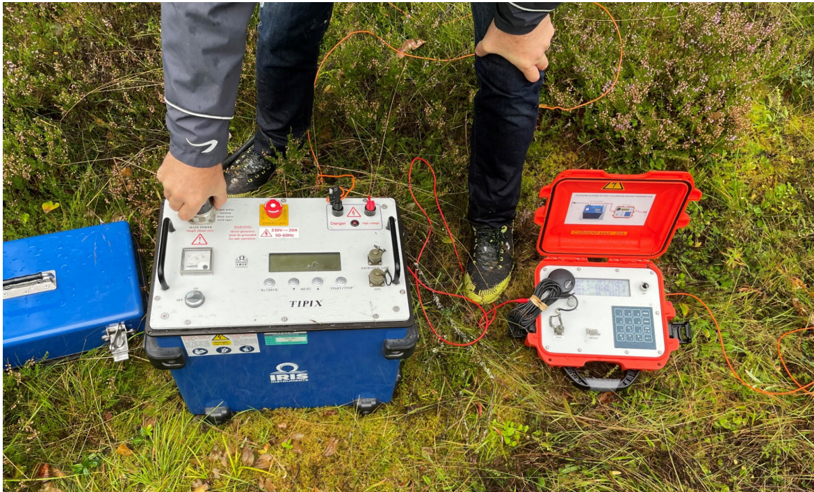
Figur 2. Sändarenhet TIPIX 3000 till vänster och I-Fullwaver till höger i bilden. Båda från Iris Instruments. Foto Mehrdad Bastani.
