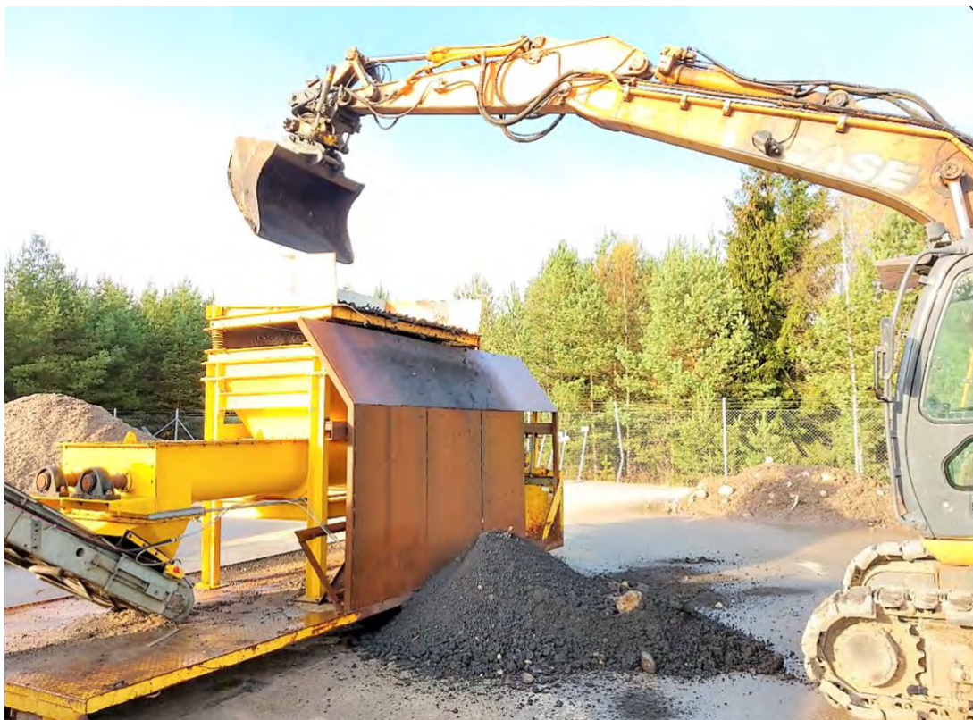
Bild 4. Lastning av förorenad jord in i jordtvätten. Materialet på marken har avskilts av gallret.
