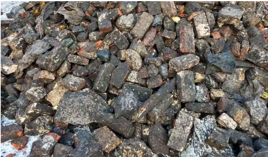
Bild 1. Siktat material i storlek >100 mm. Tegel är dominerande
