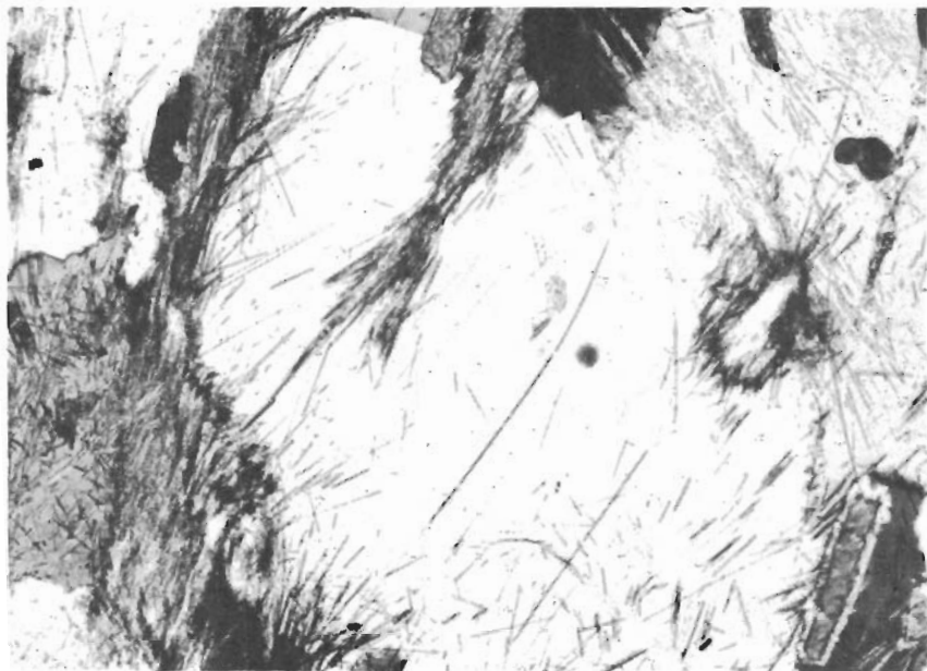
Fig. 29. Slipprov av kvarts-sillimanitfläck i kalileptit (jfr fig. 28). 250 m SV om Håsthällstorp (5d), Ödeby församling. 2 nic., 80 x. Foto H. Wikman 1972. Thin section of quartz-sillimanite spot in potassic leptyte. 250 m SW of Håsthällstorp (5d).
