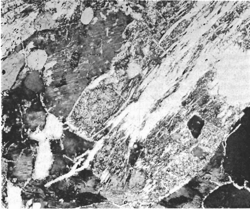
Fig. 37. Sillimanit genomsätter omvandlad cordierit i glimmerskiffer. 200 m väster om Solberga (5e), Olaus Petri församling. 2 nic., 80 x. Foto H. Wikman 1972. Sillimanite penetrating altered cordierite in mica-schist. 200 m W of Solberga (5e).
