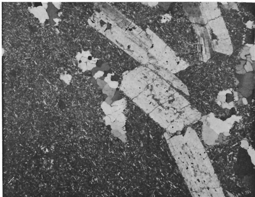
Fig. 30. Biotit-magnetitrik trakyt med kvartsmandlar. Strökornen består av delvis antipertitisk albit. + nic., \times 21 . Mertainen (4c).
