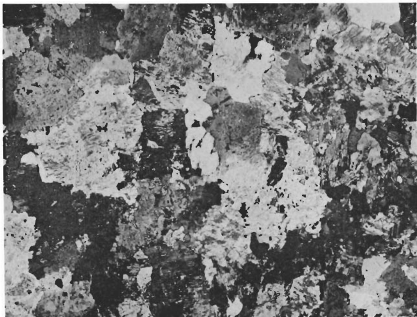
Fig. 43. b) D:o detalj av grundmassan, som övervägande består av "eutektperitisk" mikroklin samt något hornblände och kvarts. + nic., \times 27 .
