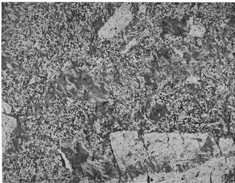
Fig. 33. Albitporfyr. Strökorn av albit i en grundmassa av albit, magnetit och sekundär biotit. — nic., \times 21 . Pahtavaara gamla koppargruva (8d).
