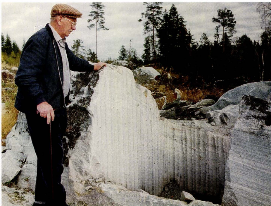
Färgbild 28. Kanalsömborrade avlossningsytor efter uttag av råblock av kyanitförande metagråvacka för sågning till golvplattor. Small quarry of natural stone in kyanite-bearing metagreywacke. RN 65876/13575. Norra delen av Hålsjöberget. Foto P.H. Lundegårdh 1987.
