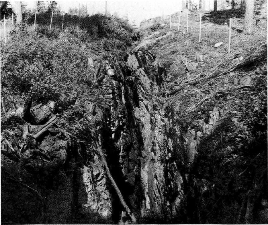
Fig. 42. Vegerbols gruvor: 285 m lång brytgrav i brantstående malmkvartsgång med flera schakt i botten. Gruvorna har drivits på silverhaltig blymalm.
