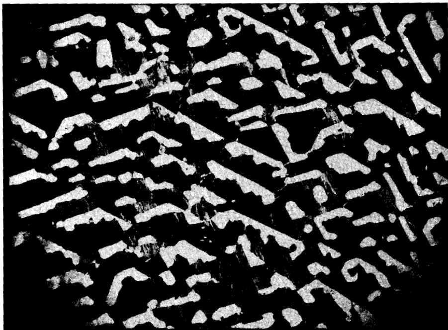
Fig. 16. Samma skriftgranit som i fig. 15, ca 20 ggr först. och sedd i mikroskop i korsat polariserat ljus. Kvartsen vit. I den svarta fältspaten ses ljusare tvillinglameller, anordnade snett nedåt mot höger.
