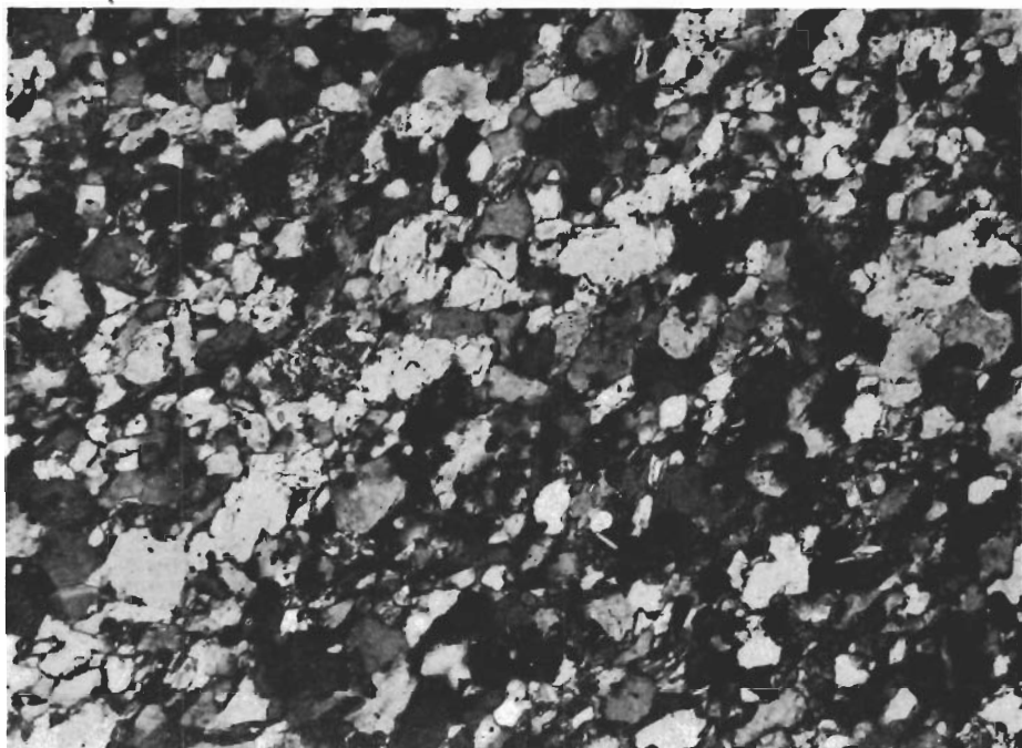
Fig. 71. Skapolitomvandlad leptit. Skapolit (vit) uppträder jämnt fördelad i leptiten, som består av albit-oligoklas och kvarts jämte något biotit. Ö om Södergruvan. Slipprov. Nic. +, \times 82 . Scapolitized leptyte. Scapolite (white) evenly distributed in the leptyte which consists of albite-oligoclase and quartz with some biotite. E. of Södergruvan. Thin section. Nic. +, \times 82 .
