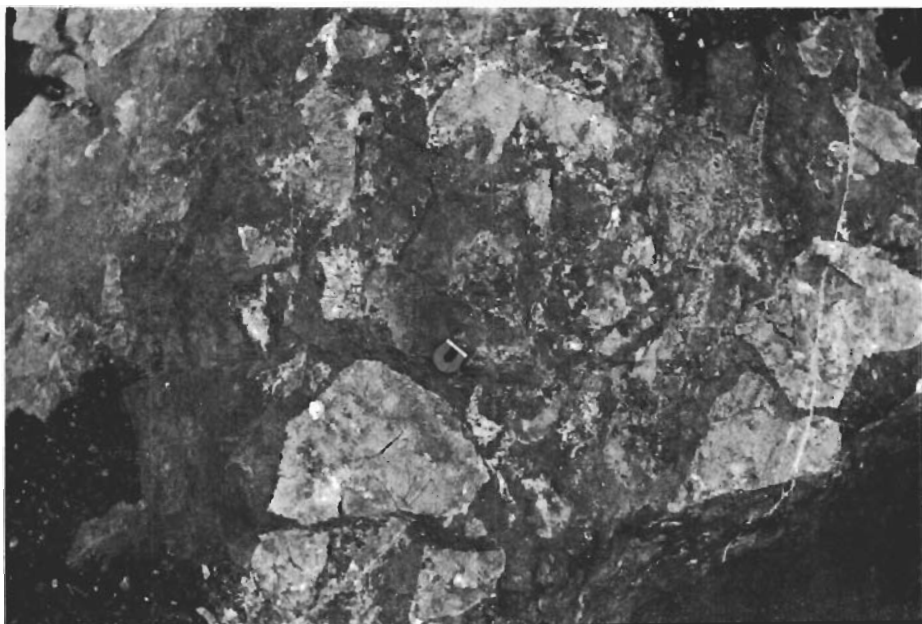
Fig. 79. Svartmalm med fragment av syenitporfyr. Tansari. Magnetite ore with inclusions of syenite-porphyry. Tansari.
