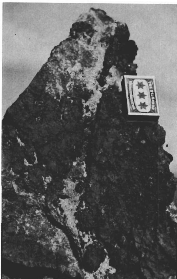
Fig. 40. Kalkrik svartmalm, delvis urvittrad. NÖ om Storgruverymningen. Calcite-rich magnetite ore, partly weathered. NE of Storgruverymningen.
