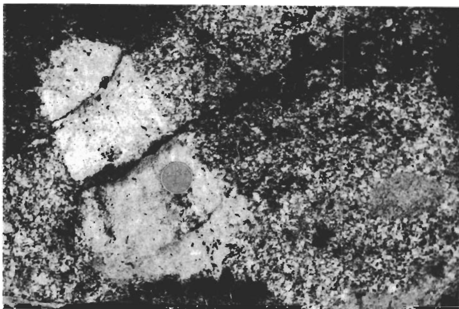
Fig. 22. Granodiorit med inneslutning av kvartsitsandsten (vid myntet) och basisk bergart (i högra delen av bilden). Kiilavaara. Granodiorite with inclusion of quartzitic sandstone (at the coin) and basic rock (in the right part of the picture). Kiilavaara.
