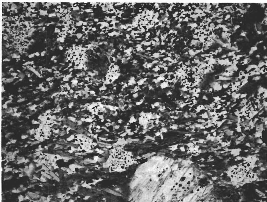
Fig. 65. Basisk leptit. Mikroclin (vita, oregelbundna korn eller aggregat), biotit (grå fjäll) och magnetit (små, svarta korn). I nedre kanten av bilden ett större skapolitkorn. N om Krangruvan.
