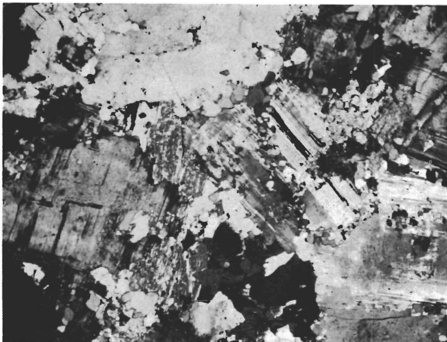
Fig. 70. Leukodiabas. Huvudsakligen albit jämte något kvarts (små, vita eller ljusgrå korn), tremolit-aktinolit och kalcit. Ö om Vaarajärvi. Slipprov. Nic. +, \times 43 .
