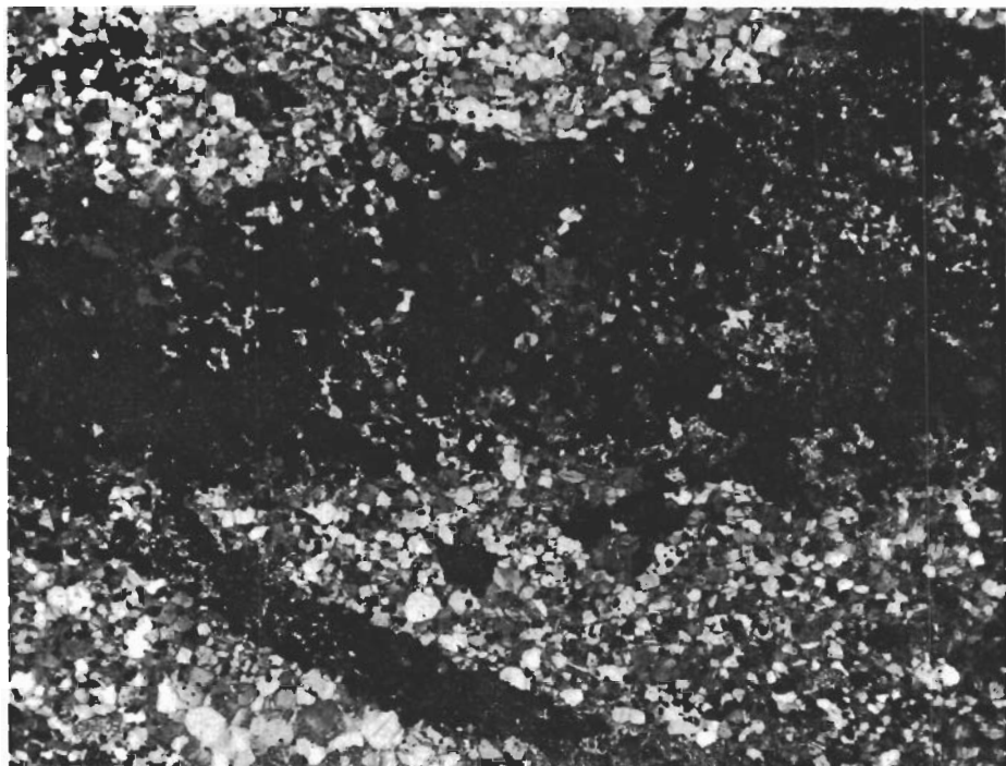
Fig. 59. Malmbreccia. Slira av hämatit (svart) i leptit bestående av mikroklin (vit) och klorit (grå). Även i hämatiten ingår klorit och mikroklin. Gruvberget, borrhål 24, 83.0 m. Slipprov. Nic. +, \times 42 .
