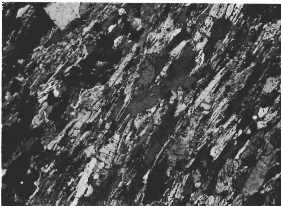
Fig. 64. Basisk leptit. Biotit (mörkgrå), tremolit-aktinolit (vitgrå) och magnetit (svart). Gruvberget, borrhål 58117, 370.3 m. Slipprov. Vanl. ljus, \times 42 .
