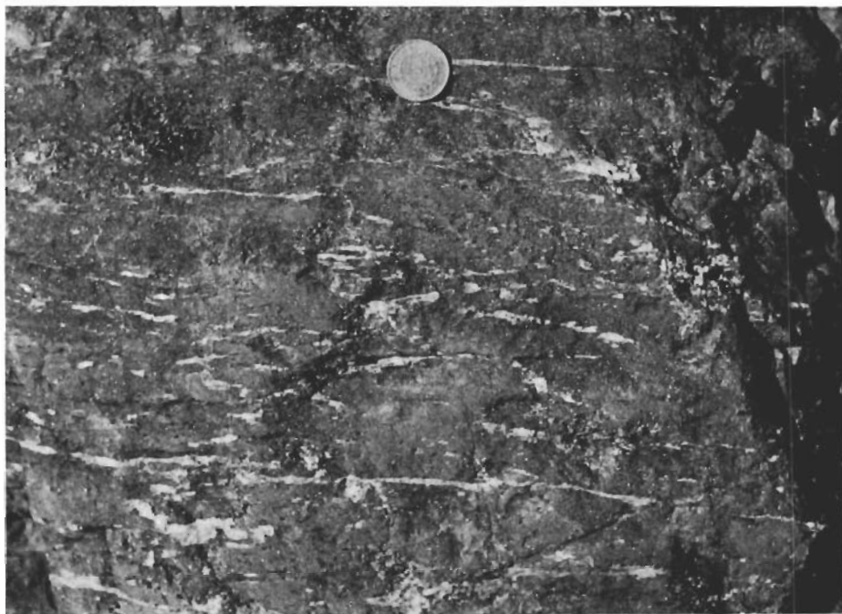
Fig. 49. Blodsten med kvartssliror. NÖ om Storgruverymningen. Hematite ore with veins of quartz. NE of Storgruverymningen.
