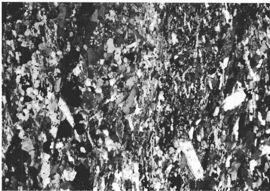
Fig. 62. Fragmentförande leptit. I en mellanmassa av mikroklin, kvarts, biotit, sericit (vita, listformade korn) och järnoxid (svarta korn) ligger ett kilformigt fragment av sericitomvandlad leptit rik på finfördelad järnoxid (i högra hälften av bilden). Gruvberget, borrhål 58109. Slipprov. Nic. +, \times 43 .
