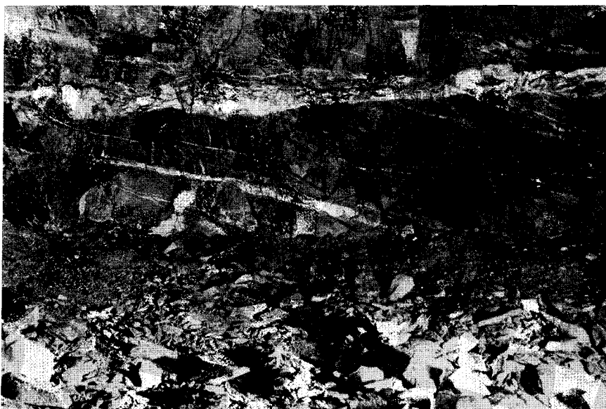
Fig. 12. Rak, flack spricka med kopparkis kombinerad med tvärställda kissprickor. Adakgruvan, 275 m nivå, malm 12, östra delen. Foto H. Eriksson.
