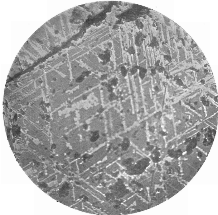
Fig. 28. Magnetit, efter oktaederytorna omvandlad i martit. Mikrofoto av polerprov med immersion, \times 200 . [Magnetite, partly martitized, Taberg mines.]
