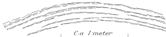
Fig. 46. Kort antiklinalbåge i valkighet på skiktyta; vertikal vägg i Örlinggruvan (jfr texten). Short anticline in linear structure in ore; vertical wall in the Örling mine; illustrating undulations of folding axis.
