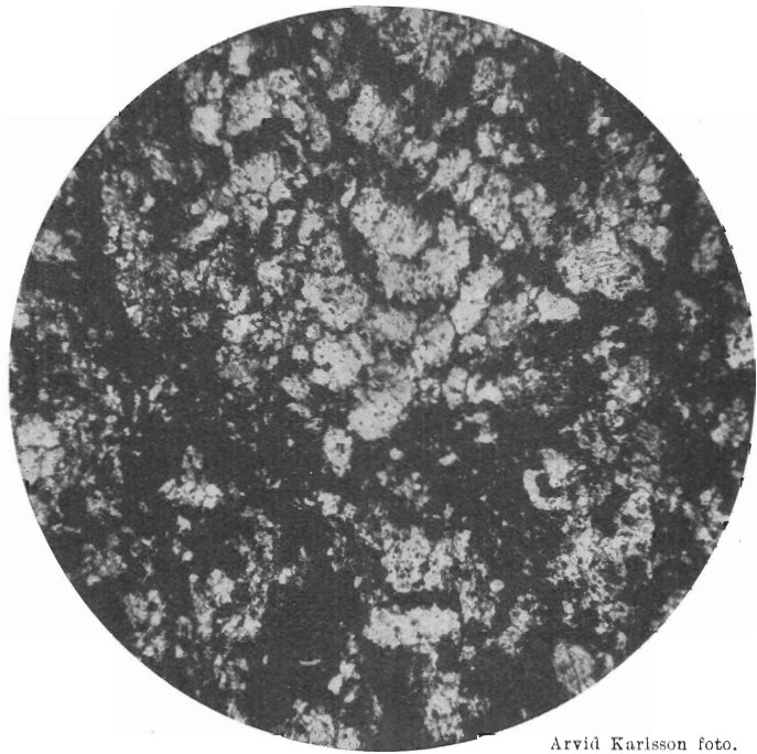
Fig. 61. Malm från Gamla Kolningbergsfältet. Slipprov, \times 20 , vanl. ljus. Magnetit (svart) och järn-mangan-spat. Ore from Gamla Kolningberg. Thin section, \times 20 , ord. light. Magnetite (black), and iron-manganese carbonate.
