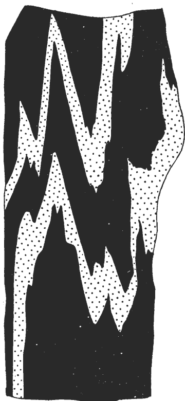
Fig. 19. Blodsten (svart) med leptitskikt (prickade). Nat. storl. (Snitt \perp axelplanet men ej fullt \perp veckaxelriktningen). Storgruvan i Norbergsby. Hematite ore (black) with leptyte layers (stippled). Nat. size. Storgruvan.
