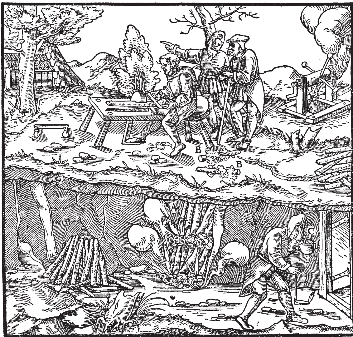
Tillmakning i en gruvgång enligt Gregorius Agricola, De Re Metallica, 1556.
