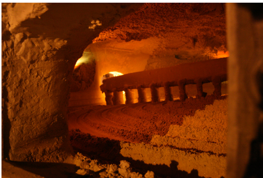
Interiör av rostningsugn från Thompson Creek, Kanada. Foto: Thompson Creek, Kanada.
