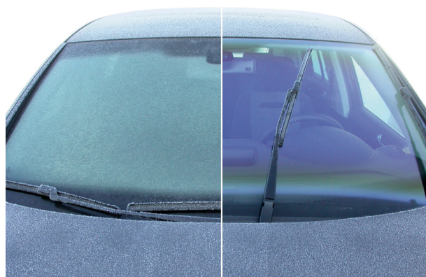
Fig 29. Volkswagens och Audis forskare utvecklar världens första vindruta som utan eluppvärmning kan förhindra isbildning. Till skillnad från uppvärmda fönster bygger denna nya innovation på en fysikalisk princip som förhindrar isbildning ner till minus 18 °C. Hemligheten ligger i en tunn, transparent beläggning av indium-tennoxid (ITO) som används på rutan. Tekniken kallas Low E, Low Thermal Emissivity, och skyddar glaset från kyla så att vattnet på den yttre ytan inte kondenserar eller fryser. Foto: Volkswagen.
