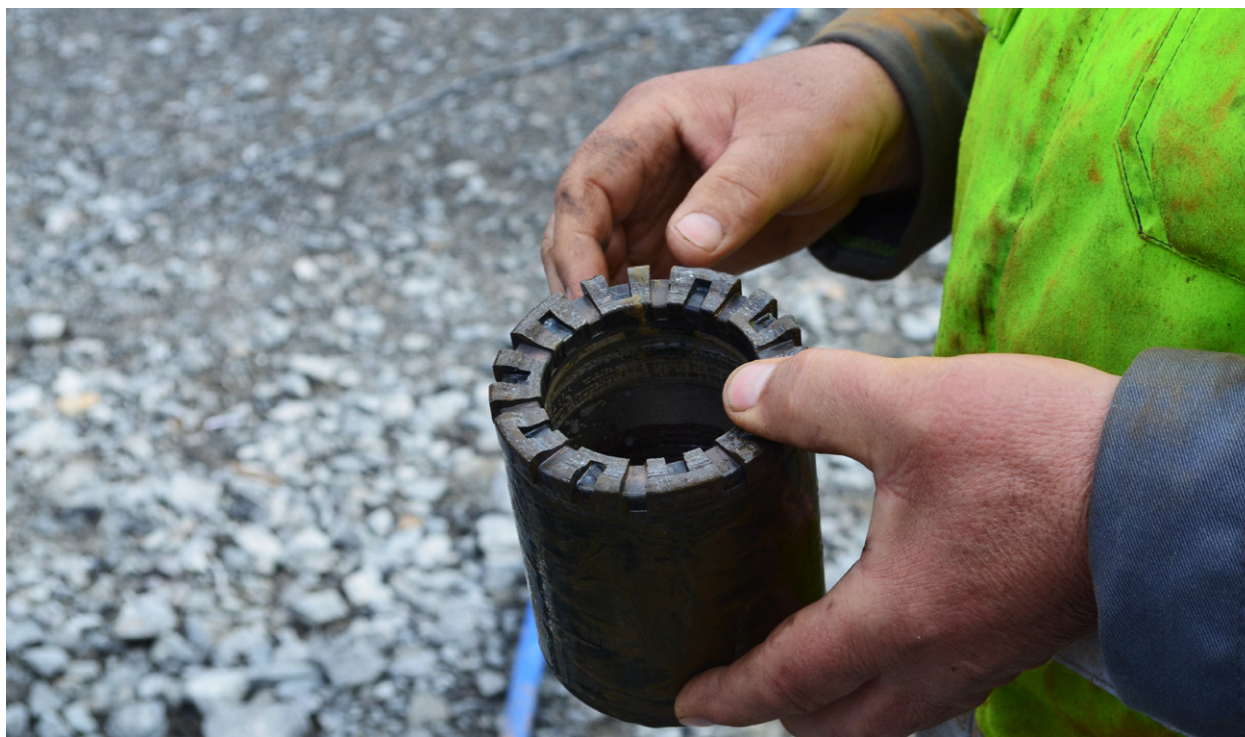
Utsliten borrhäls från diamanthörning. Borrhälsn härrör inte från prospekteringshörning utan från SGUs forskningsprojekt med djuphörning i Jämtland. Foto: Lars Norlin, SGU.
