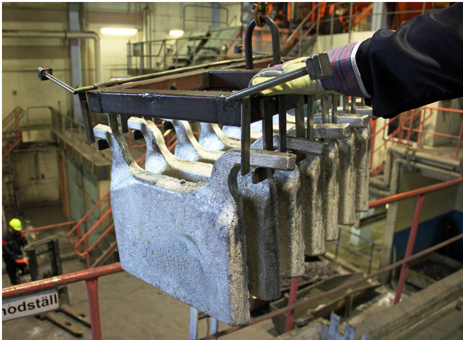
Gjutning av silveranoder i Rönnskär. Foto: Boliden AB
