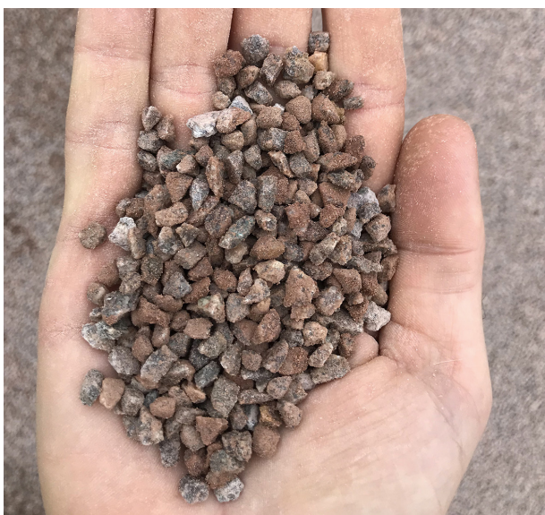
Figur 20. VSI-krossad 2/5 mm-fraktion. De flesta partiklarna av det hårda berget har efter kantnöttningsprocessen med VSI-krossningen blivit något mer rundade och egenskaper blandbarhet och pumpbarhet förbättras då avsevärt. Foto: Mattias Göransson, SGU.
