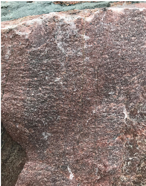
Figur 19. Grå-röd (vänster) till rött-grå (höger), finkornig, gnejsig granitoid med mycket bra motstånd mot skavande nötning, kulkvarns-värde 6 till 9 procent. I tätten finns fler bergarter men om man bryter bergarter med särskilda egenskaper för sig kan man säkra produktionen av särskilda produkter, asfalt- eller betongballast. Vyn för bilderna är cirka 12 × 12 cm. Foto: Mattias Göransson, SGU.
