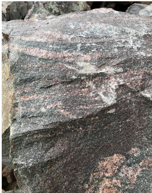
Figur 19. Grå-röd (vänster) till rött-grå (höger), finkornig, gnejsig granitoid med mycket bra motstånd mot skavande nötning, kulkvarns-värde 6 till 9 procent. I tätten finns fler bergarter men om man bryter bergarter med särskilda egenskaper för sig kan man säkra produktionen av särskilda produkter, asfalt- eller betongballast. Vyn för bilderna är cirka 12 × 12 cm. Foto: Mattias Göransson, SGU.
