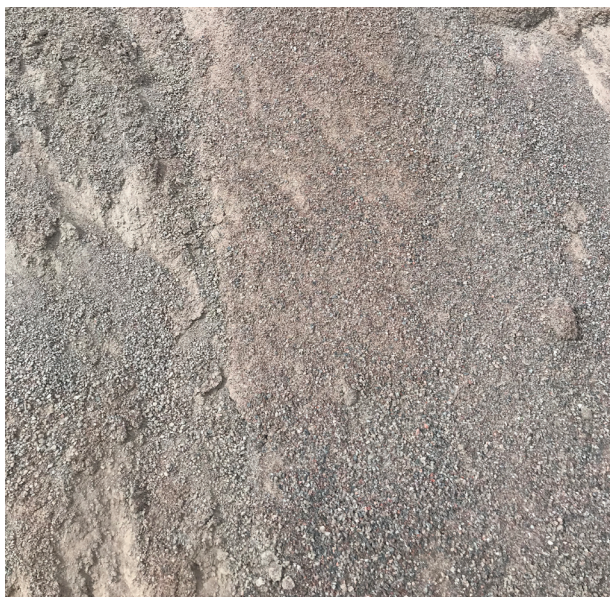
Figur 16. Krossat berg för betong, fraktion 0/8-mm, som tillverkats av finkornig, svagt gnejsig, glimmerfattig granit. Foto: Mattias Göransson, SGU.
