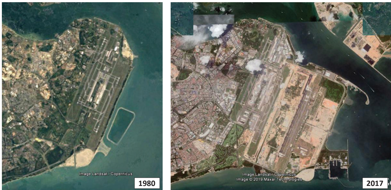
Figur 15. Den faktiska landytan är en viktig parameter för att möjligheterna till utveckling av näringsverksamheten och för att samhället ska kunna växa ska vara goda. I Singapore har man under två generationer bunkrat upp havssand för att expandera sin egen landyta. Likt Holland har man byggt barriärer av hållfast sten som diabas för att förhindra att sanden försvinner ut i havet igen. Foto: Google Earth. The actual land surface is vital for the future development, expansion of the industry. In Singapore, sand from the sea has been used for land reclamation during the last two generations, which has increased the total land area.
