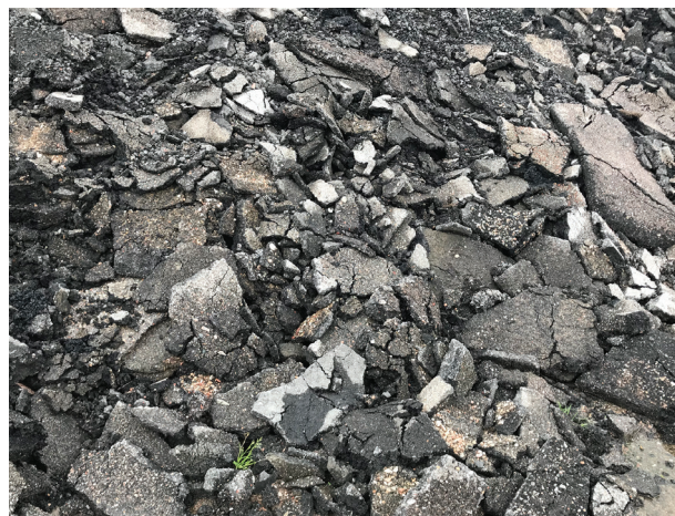
Figur 17. Upp mot 30 till 50 % av den gamla asfalten kan användas i produktionen av ny asfaltbetong. Olika återanvända asfaltprodukter skiljer sig åt. Produkter som fräsmassor är enklare att återanvända, och massorna blandar sig bättre i den nya asfalten än produkter som uppbrutna massor. Foto: Mattias Göransson, SGU.
