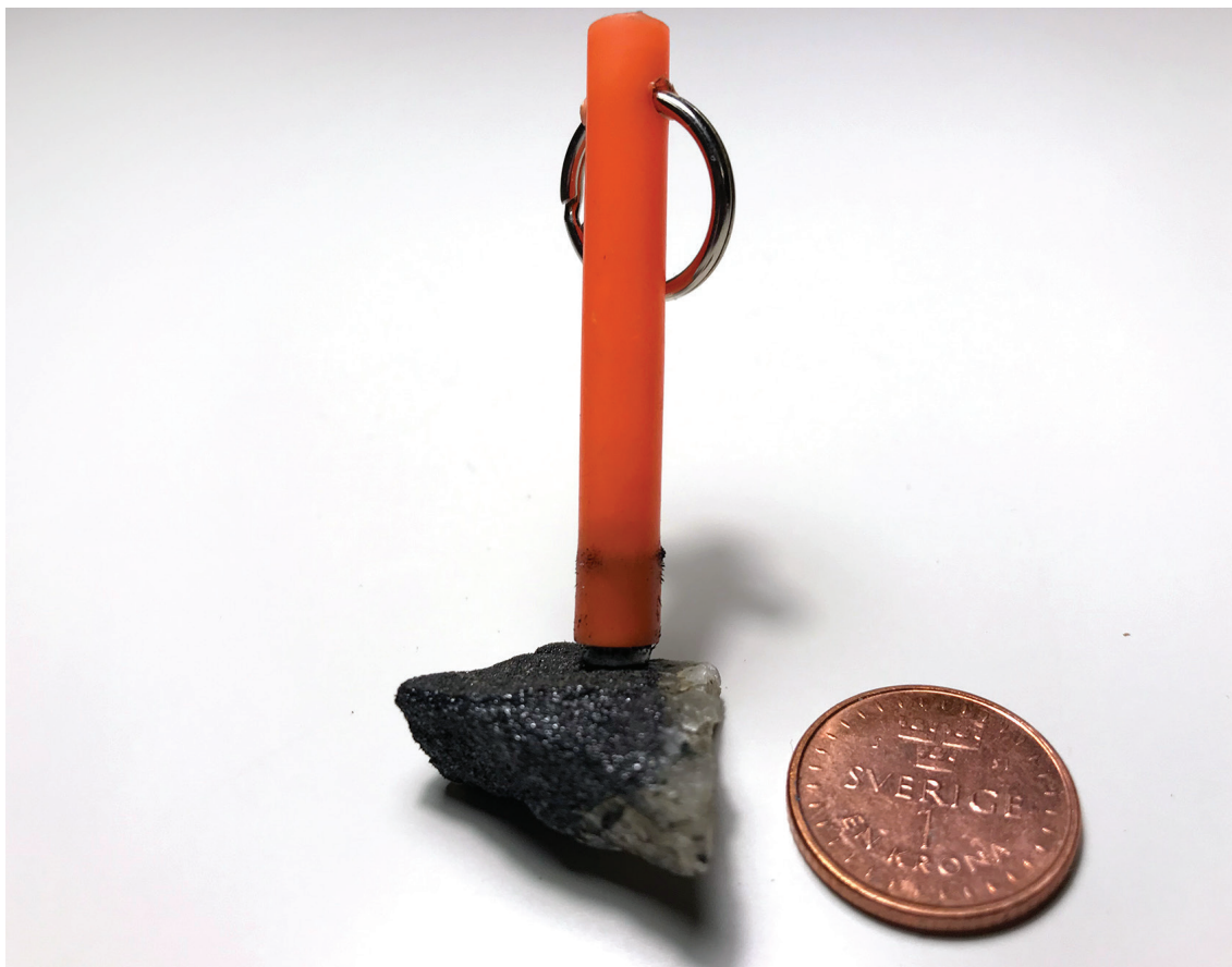
Figur 3. Bilden visar en bit apatitjärnmalm från Lekomberg i Bergslagen. Järnmalmer består ofta av mineralet magnetit som är magnetiskt och som är lätt att identifiera med en magnet. Ett tränat öga kan också hitta fosformineralet apatit i järnmalsbiten. Vad som inte syns, ens för ett tränat öga, är att denna malmtyp också innehåller sällsynta jordartsmetaller (REE), just denna malmbit ungefär 0,07 % REE. Detta går bara att ta reda på genom att göra en kemisk analys av provet och detta gäller förekomsten av de flesta av de kritiska metaller i denna rapport – det syns inte på malmen eller på gruvavfallet vilka och hur stor mängd av kritiska metaller de innehåller, det måste undersökas med kemiska analysmetoder. Foto: Helge Reginiussen.
