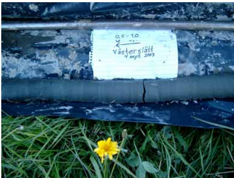
Figur 20. Gytjig sulfidhaltig silt från Västerslätt utanför Umeå.
