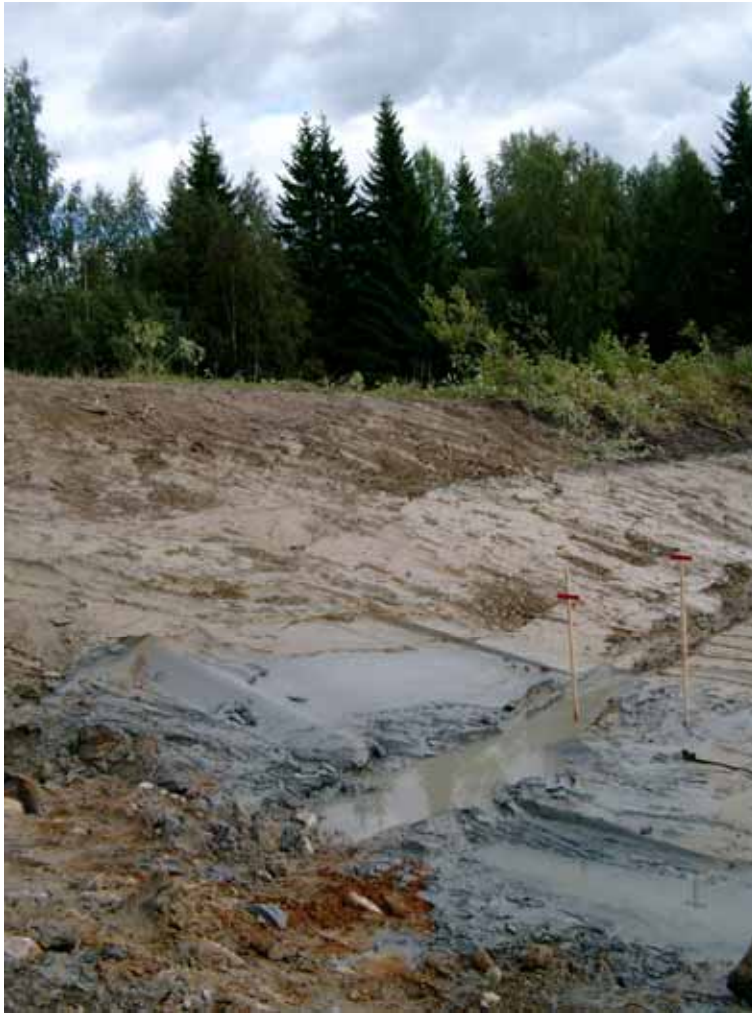
Figur 21. Blågrå silt vid ett vägbygge i Gubböle mellan Umeå och Vännäs. Den närmast markytan liggande jorden har oxiderat och har en roströd färg. Denna jord har dock låga svavelhalter och den oxiderade jorden uppvisar ej de låga pH värden som karakteriserar de sura sulfatjordarna.
