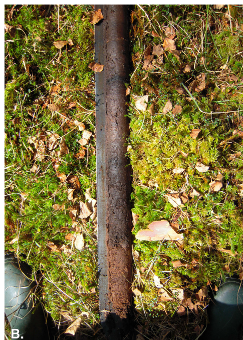
Figur 2. A. Undersökningarna utförs i ett rutnät av borrh punkter (vita punkter) över torvmarken (i grönt) där torvens egenskaper bestäms i fält. B. Bilden visar ett exempel på en borkärna från en torvmark.
