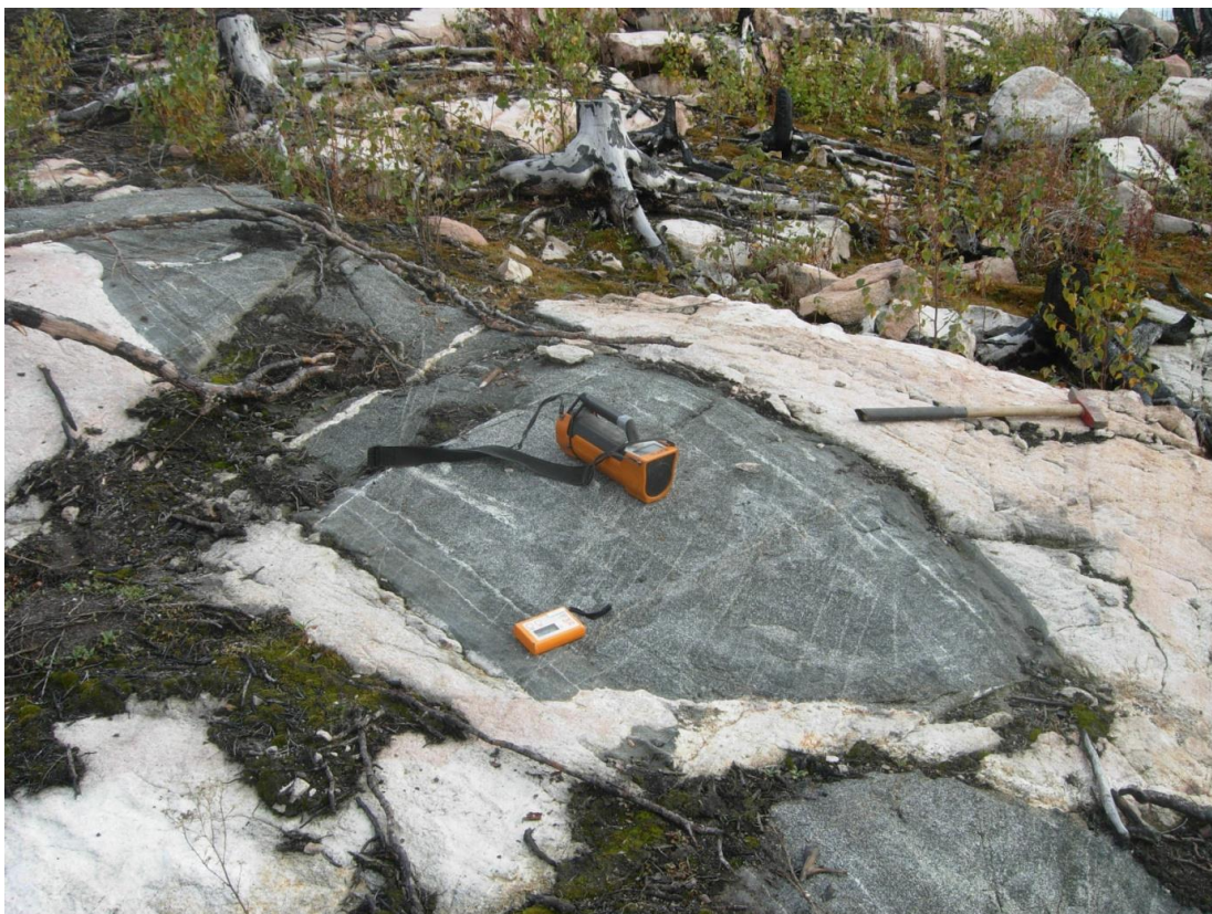
Figur 30. Mätning med spektrometer på amfibolitgång som slår igenom granit av Malingsbotyp (6650742/558742). Foto: Johan Jönberger
