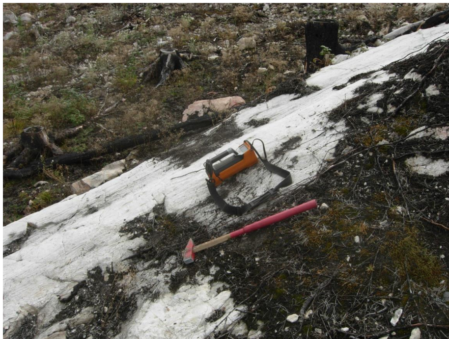
Figur 10. Mätning med spektrometer på hydrotermalomvandlad ryolit (6651178/559447). Foto: Johan Jönberger.
