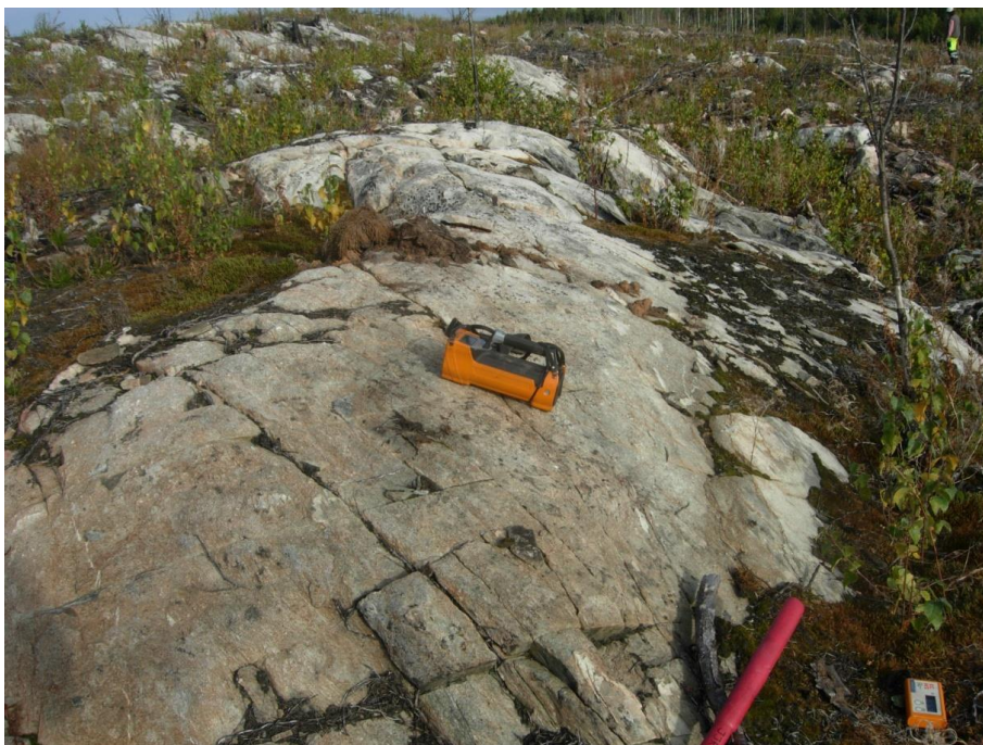
Figur 14. Mätning med spektrometer på den högmagnetiska daciten (6652414/559077). Foto: Johan Jönberger.
