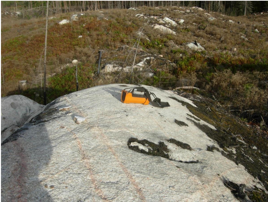
Figur 24. Mätning med spektrometer på den stängliga graniten (6652431/559651). Foto: Johan Jönberger.
