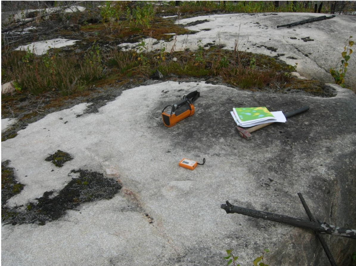
Figur 39. Mätning med spektrometer på den toriumanomala graniten av Malingsbotyp mellan sjön Åmänningen och Märresjön (6646903/557961). Foto: Johan Jönberger.
