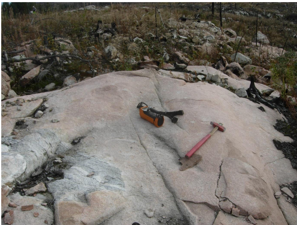
Figur 35. Mätning med spektrometer på Malingsbogranit (6650742/558742). Notera den bandade, ljusgrå granitinneslutningen. Foto: Johan Jönberger.
