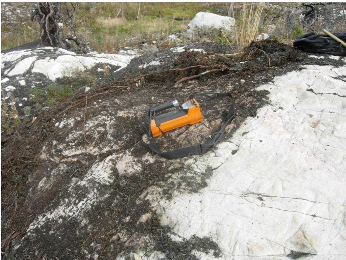
Figur 8. Mätning med spektrometer på ryolit (6651178/559447). Foto: Johan Jönberger.
